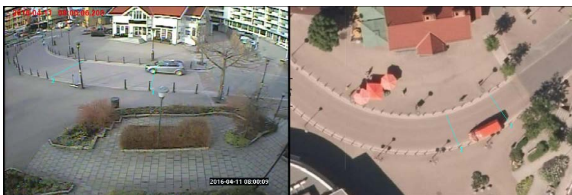
Figur 14. Beregning av fart på kjøretøy på Bekkestua torg ved hjelp av imaginære linjer i vegbanen. Bildet til høyre er hentet fra Finn kart, bildet til venstre viser hvordan dette er tegnet inn i kamerabildet.
