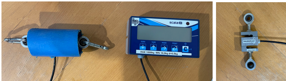
Figur 8: Kranvekten som ble brukt i forsøkene. Til venstre er vektcellen beskyttet av en avklippet bit av et varerør med slisse og hull til ledningen for å unngå å skrape opp vektcellen underveis i trekkingen. Til høyre vises vektcellen uten beskyttelsen. (Foto: Drammen kommune)
