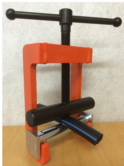
Figur 4: Rørskviser. Åpningen i rørskviseren er avstanden mellom den svarte og den blanke sylindren, og måles med meterstokk. Foto: (Haugaland Rørhandel AS, 2023).
