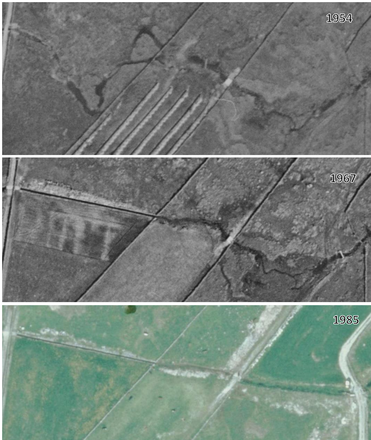
Figur 7. Utretting og kanalisering av elveløpet i øvre del av det sørøstre sideløpet, utrettingen skjedde i perioden 1954 til 1985, elveløpet på strekningen er redusert fra 216 til 164 m.
