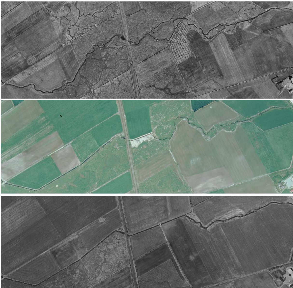
Figur 20. Utretting og kanalisering av elveløp nedstrøms og oppstrøms jernbanelinjen. Utrettingen i dette området skjedde i perioden 1954 til 1994, elveløpet på strekningen er redusert med fra 1222 til 1043 m. På det øverste bildet ser en også tydelig hvordan jorden blir grøftet i forbindelse med oppdyrking til jordbruksland.
