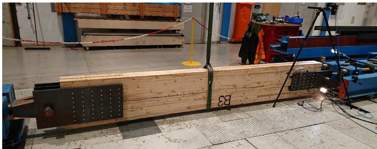
Figur 118 Prøvestykke for blokkutrivning (B) montert i prøveriggen for aksuell strekkbelastning.
