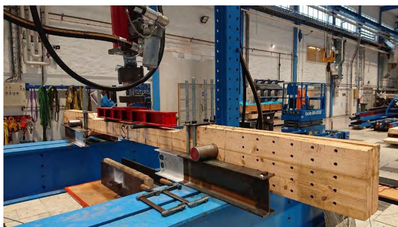
Figur 114 Fire-punkts oppsett for bøyeforsøk for måling av påsatt kraft og forskyvning.
