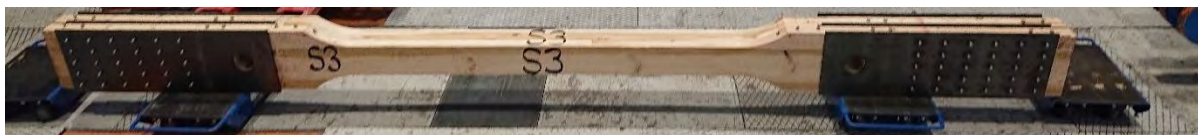
Figur 109 Strekkprøve klargjort for prøving
