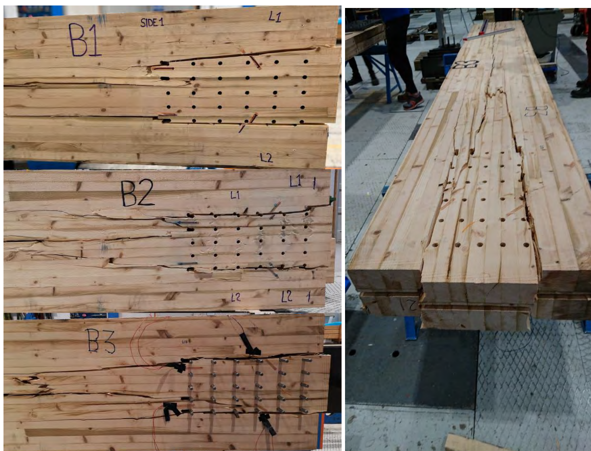
Figur 123 Bruddsoner i prøvestykkene
