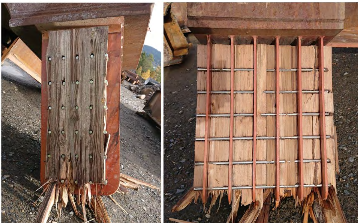
Figur 9 Knutepunkt K-17.b viser et rent blokk-skjærbrudd
