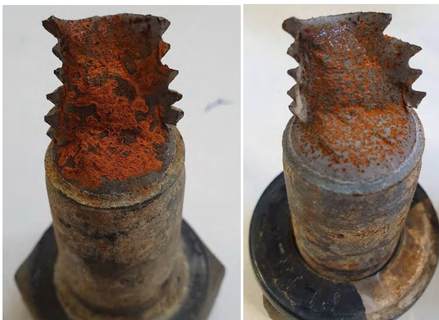
Figur 161. Korrodert bruddflate på Bolt B-2.4 og B-2.2
