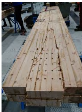
Figur 149 Blokkutrivning. Forsøk med diagonal 13.
