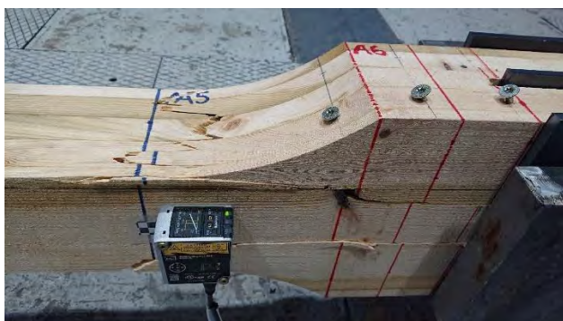
Figur 111 Strekkprøving, brudd ved innfestningen.
