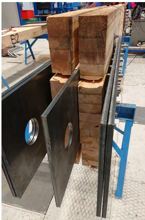
Figur 122 Blokkutrivning av dybelgruppe etter testing.
