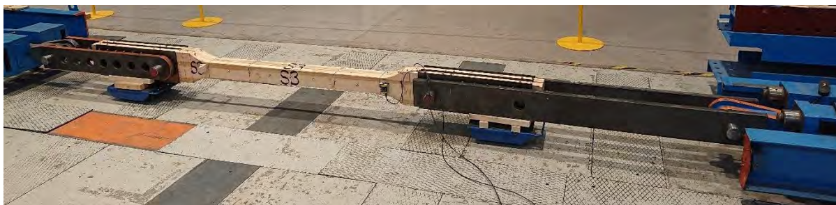
Figur 110 Prøving av strekkstyrke.
