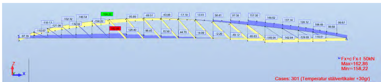
Figur 34 Aksialkrefter fra økt temperatur i stålvirikal
