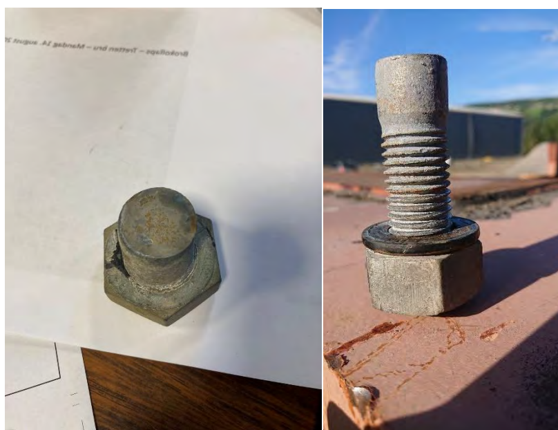
Figur 89 Avskjæring av bolter mellom tverrbærer og fagverk i knutepunkt 31, til venstre bolt fra SINTEFs undersøkelse, til høyre fra knutepunkt 31.
