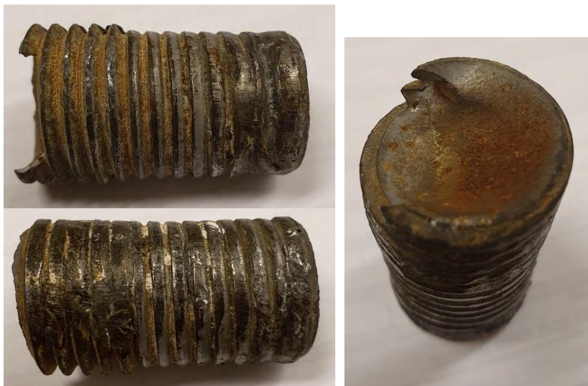
Figur 154. Bolt B-8-6, M27 type 10.9 funnet i knutepunkt 29 nedstrøms
