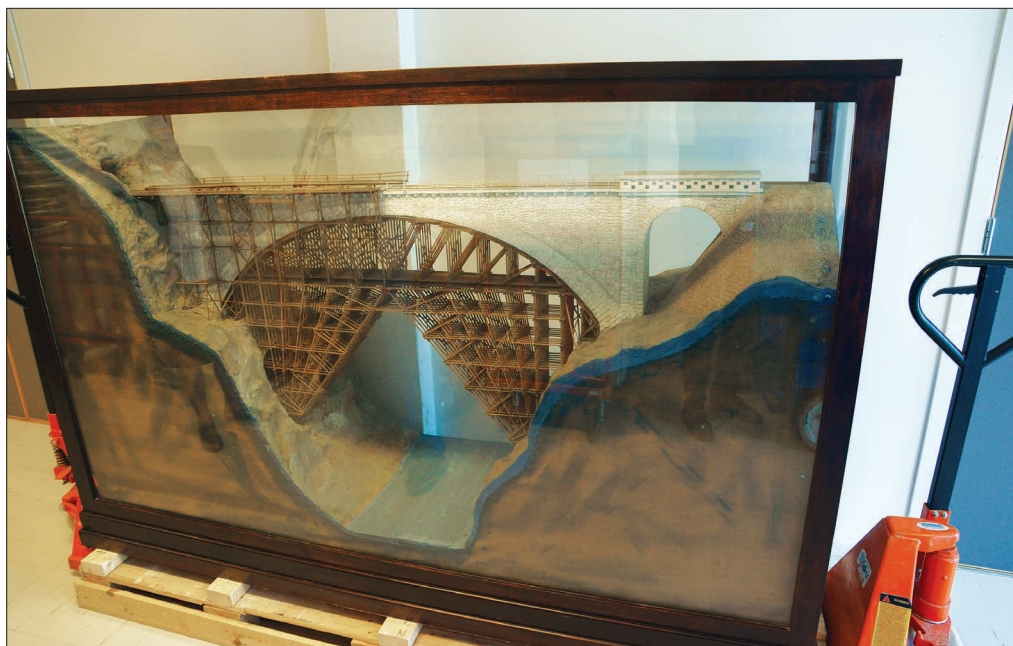
Museet overtok i 2016 en stor modell av Orkla bru (under bygging) i skala 1:50. Modellen kom fra Material- teknisk laboratorium hos NTNU i Trondheim. Model- len er bygget på kontrakt fra Hovedstyret for Statsbanene og ble laget til Jubileumsut- stillingen på Frogner i Oslo i 1914. Modellen var en av flere utstillingsgjenstander NSB hadde med på utstill- ingen. Den ble i løpet av året satt ut i utstillingslokalene i museets hovedbygg. Foto: Kjetil Næss.
