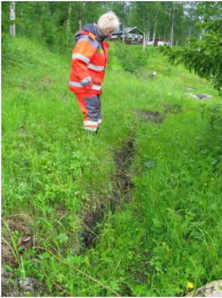
Figur 15.5.3—1 — Bilde til venstre viser en sprekk i terrenget ovenfor en punktering med utvasking på Breivikeidet. Bilde til høyre viser utvasket vegbane etter endret artesisk trykk på Valebø, i Telemark (Foto: Elisabeth Gundersen og Bjørn K. Dolva, Statens vegvesen)
