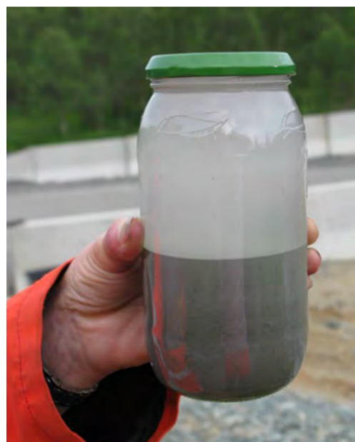
Figur 15.7—2 — Hjulstrøms diagram til venstre (kilde: Selmer Olsen [265]). Bildet til høyre viser utvaskingen fra Rv. 91 på Breivikeidet (Foto: Elisabeth Gundersen, Statens vegvesen)
