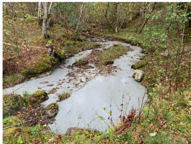
Figur 15.5.3.5—1 — En totalsondering som førte til punktering med utvasking på Åndalsnes
