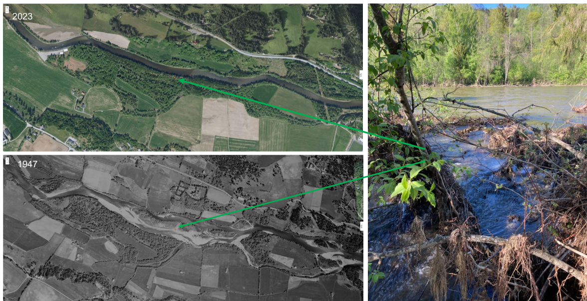
Figur 18 Under uværet «Hans» i august 2023 oppstod det brudd i vollen som førte til at vann igjen rant inn i et tidligere flom-/sideløp (foto til høyre). Geografisk plassering av «bruddet» er angitt i flyfotoene fra 1947 og 2023 (fotoer til venstre). Legg merket til bruddet skjedde i et område hvor det tidligere var innløp til et flom-/sideløp. Foto til høyre: Knut Marius Myrvold, NINA.
