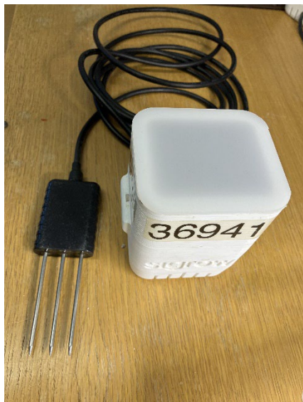
Figur 8. Eksempel på en sensor som måler fuktighet i jorda. "Gaffelen" stikkes ned i jorda, mens boksen henges opp i kulturen og måler bl.a. lufttemperatur og -fuktighet. Foto: Kaia Slågedal.
