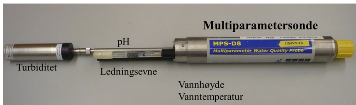
Figur 8. Multiparametersonde (MPS-D8) som er benyttet på stasjonene for kontinuerlige automatiske målinger.
