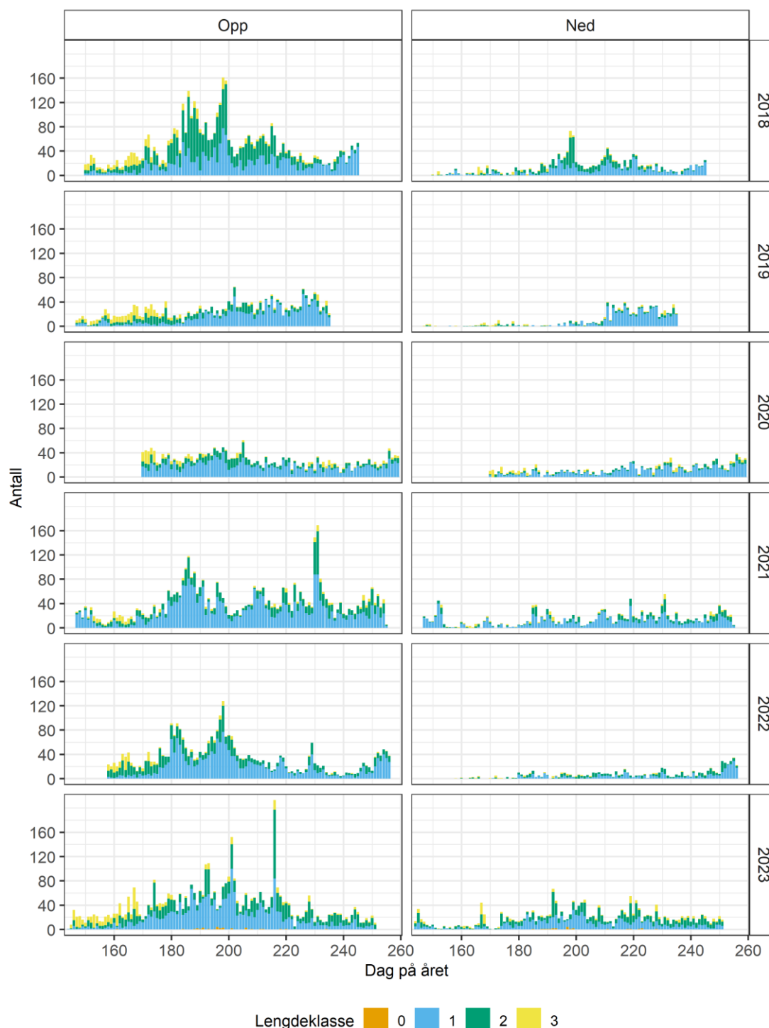
Figur 9. Estimert døgnvis opp- og nedvandring av fisk (laks og andre arter) i gitte lengdeklasser (0: <45 cm, 1: ≥45 - < 65 cm, 2: ≥65 - < 90 cm og 3: ≥90 cm) i årene 2018-2023 i Kárásjohka inkludert interpolert data fra perioder uten dekning. Dag 160 tilsvarer 9. juni, dag 200 tilsvarer 19. juli og dag 240 tilsvarer 28. august.
