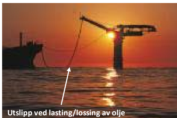
Figur 19: Potensielle hendelsestyper ved lossing av olje over til et tankskip. Bilde: Statoil.
