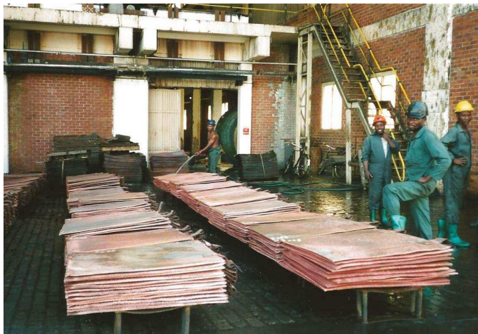
Figur 47: Kobber utfelt på 1 m 2 katodeplater i kobbergjenvinningsanlegg i Zimbabwe (COWI 2002)
