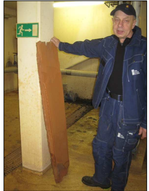
Gipsbelegg fra reaksjonstank
