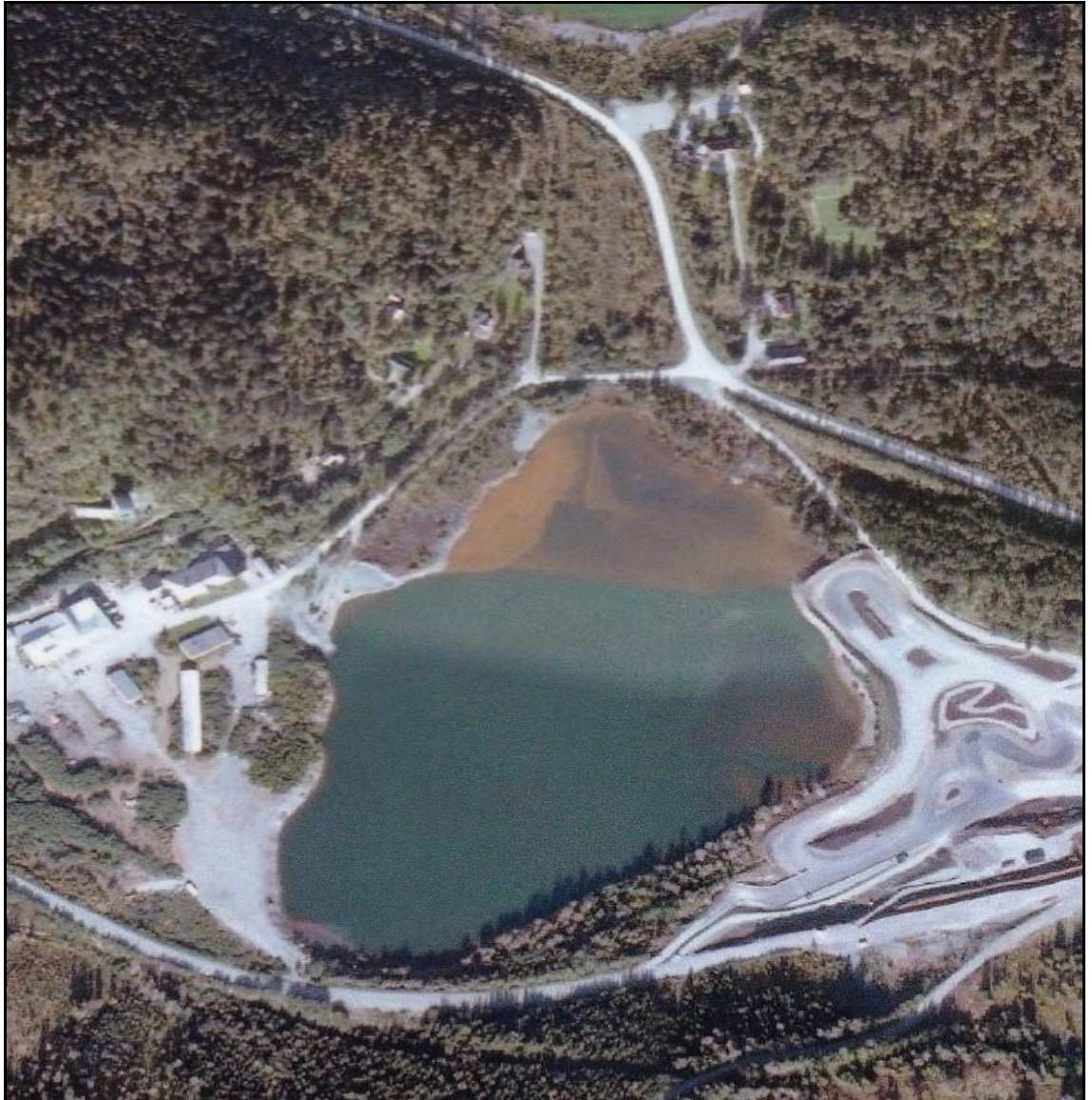
Figur 21: Fagerlivatnet slik det ligger i dag. Sprekker som kommuniserer med gruverommene under kan være vannførende. Det er uklart hvilke deler av vannet som er mest utsatt.
