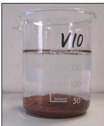
CuO-slam fra et Færøysk vaskevann fra fiskegarns-impregnering
