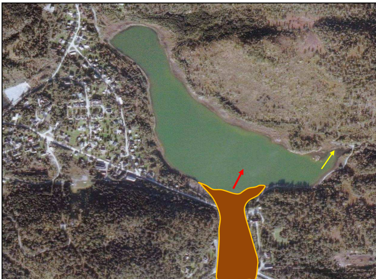
Figur 22: Bjørnlivatnet med gråbergdeponiet ved Vedmyrstoppen (brunt felt). Utløpet fra Fagerlivatnet er markert med rød pil, mens utløpet fra Bjørnlivatnet er merket med gul pil. Vannstrømmen fra Fagerlivatnet går sannsynligvis rett mot utløp i Bjørnlivatnet slik at mesteparten av innsjøen ikke berøres av forurensningen.
