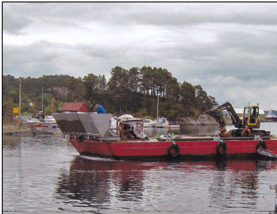
Figur 16: Capping med spesiallekter. Utleggingsaggregatet sitter i baugen. Utstyret er norskprodusert og fraktes fra sted til sted med bil. Med GPS-styring gir utstyret en meget presis utlegging
