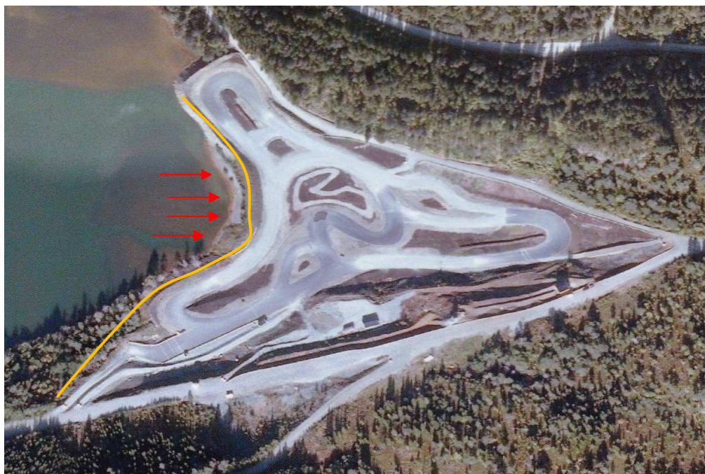
Figur 19: Berggulmyra deponiområde med motorbanen. Legg merke til utfellingene ved de røde pilene. Utfellingen tyder på utstrømming av forurenset vann. En reaktiv grøft kan muligens plasseres langs den gule linjen.
