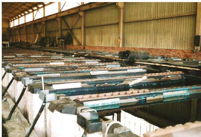
Figur 46: Utsyn over elektrolysekar i et stort kobbergjenvinningsanlegg i Zimbabwe (COWI 2002)
