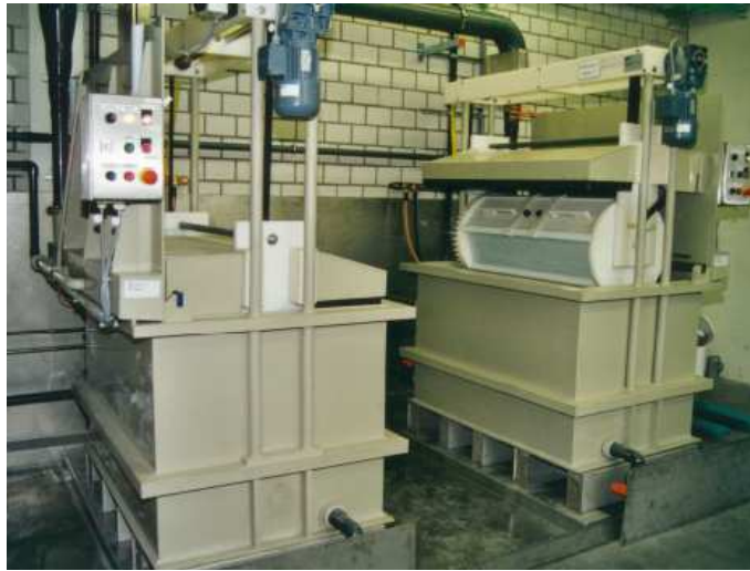
Figur 45: Elektrolyseanlegg med tromler fra det tyske firma Gütling. (Foto: Gütling)
