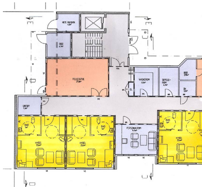
Deler av planløsning 1.etasje, bofellesskap ombygd del
