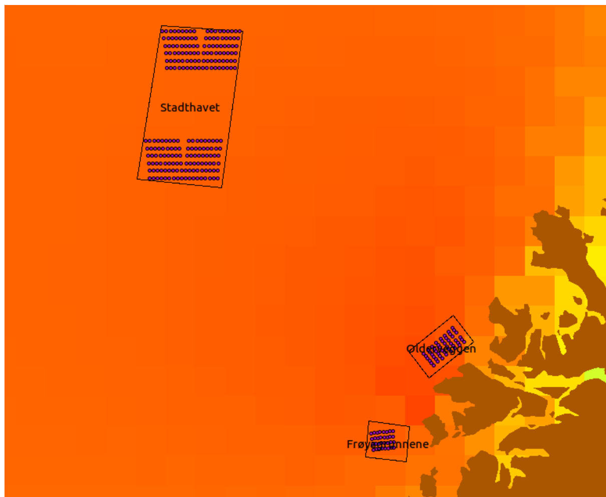
Figur 11 Utredningsområdene Stadthavet, Olderveggen og Frøyagrunnene. De røde punktene indikerer turbinposisjoner ved stor utbygging. Bakgrunnsfargen indikerer midlere vindstyrke i 100m fra NEHI der blått indikerer svakere vind, gult middels og rødt sterkest vind.
