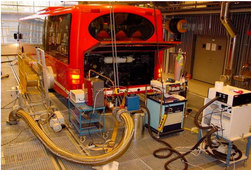
Figur 22. VTTs avgasslaboratorium med programmerbar rullende landevei for tunge kjøretøy i Vantaa utenfor Helsinki (Nylund, VTT, 2005).
