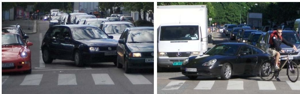
Figur 31. Bilister som har feil plassering i kryss 5, og derfor blokkerer det midtstilte sykkelfeltet (Foto: M. Sørensen).
