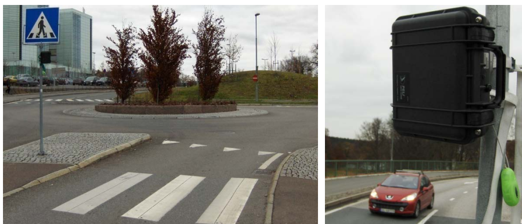
Figur 4. ICONS TMS-SA mobil radarmåler (Foto: M. Sørensen).
