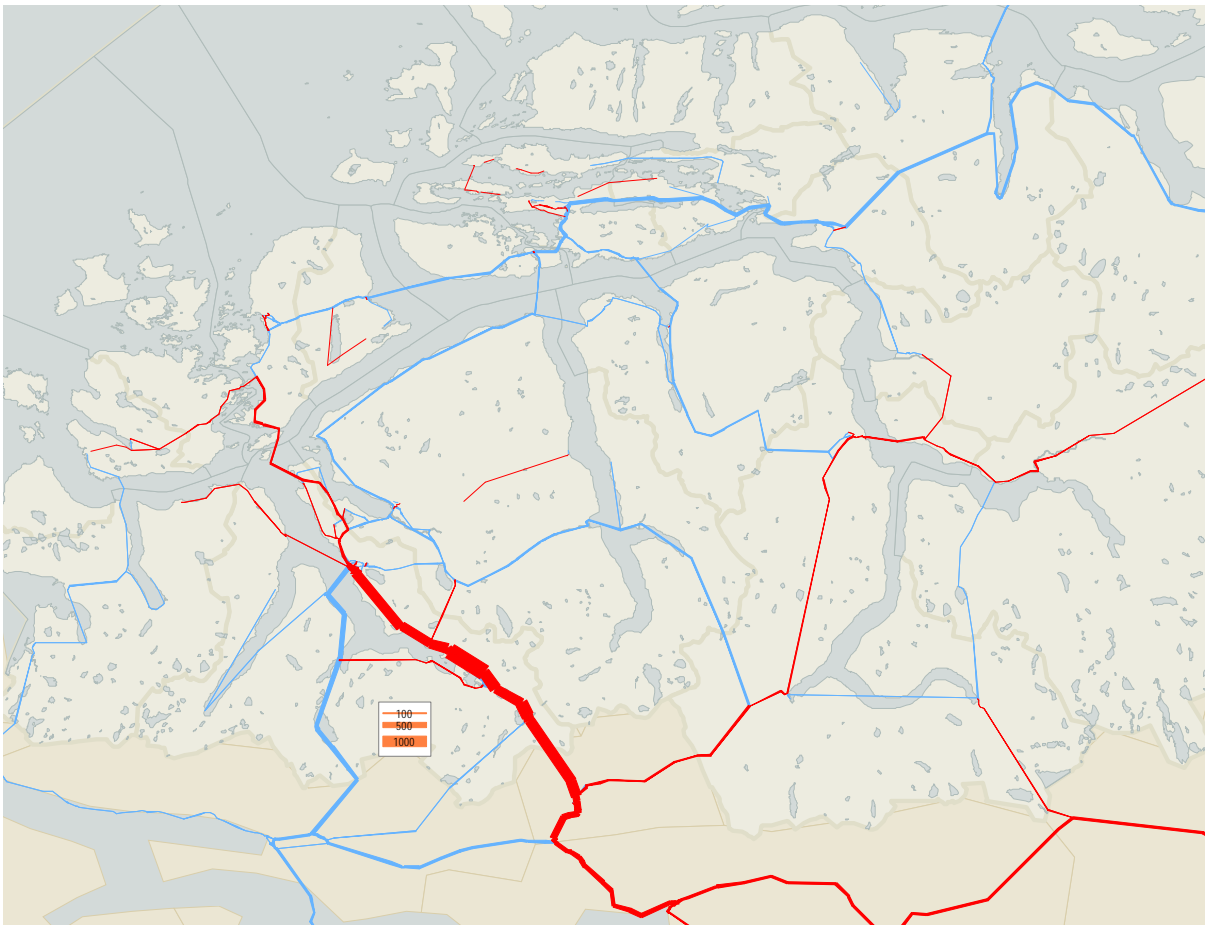
Figur 0-5 Rene vegvalgseffekter, endring fra alternativ 0 (referanse) til alternativ 1 (uten bompenger på Kvivsvegen=, VDT (rød = økning, blå = reduksjon).
