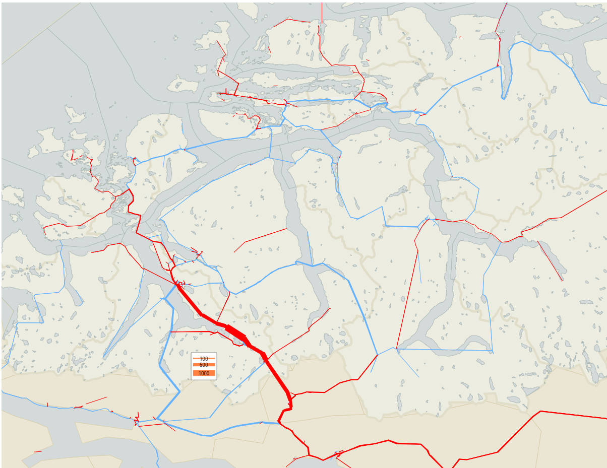
Figur 0-8 Endring i volumer fra alternativ 0 (referanse) til alternativ 5 (fullpris NOK 60 for privatbiler på Kvivsvegen), VDT (rød = økning, blå = reduksjon).
