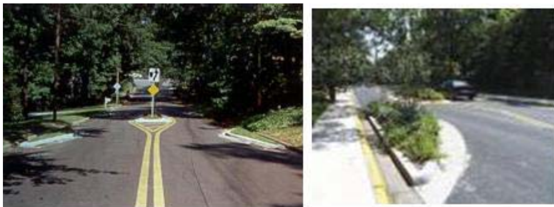
Figur 2.17: Sideforskyvninger med beplantning i USA. Kilde: http://www.fhwa.dot.gov/environment/tcalm/index.htm (14 aug. 2009).
