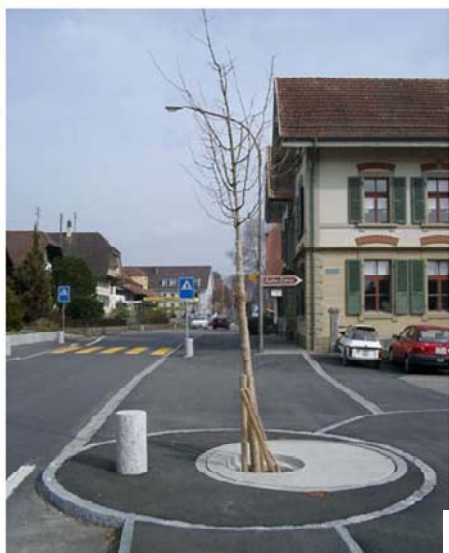
Figur 2.14: Sideforskyvning, i Hauptstrasse, Wohlen b. Bern; på veg inn i tettstedet og ut av tettstedet. Kilde: Beyeler & Roduner (2004).
