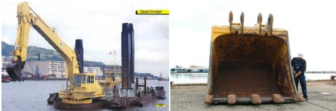
Figur 2. Til venstre: Ombygget gravemaskin på lekter ( www.udl.com.hk ) Til høyre: Stor 14 m 3 graveskuff ( www.rohde-nielsen.dk )
