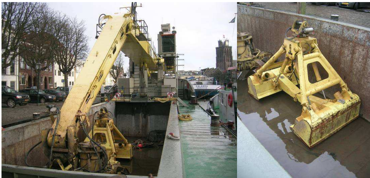
Figur 6. Grabb med en fast arm med hydraulisk lukking (Boskalis, Nederland)
