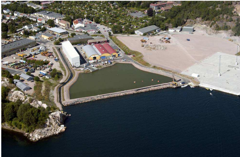
Figur 25. Strandkantdeponi med filter som slipper overskuddsvann tilbake til sjø, Kongsgårdbukta, Kristiansand (Tor Kviljo, Terrateknikk)
