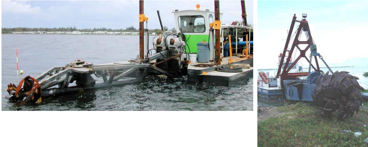
Figur 10. Kutterhode (foto til venstre fra www.dredgebrokers.com og foto til høyre fra www.kogsubic.com )
