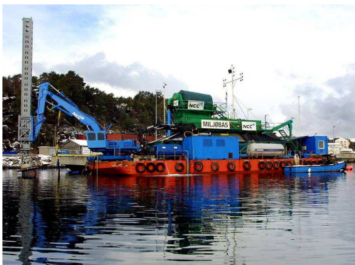
Figur 8. Sugemudringsutstyr montert på en gravemaskin på lekter (Haakonssvern, Bergen, NCC)
