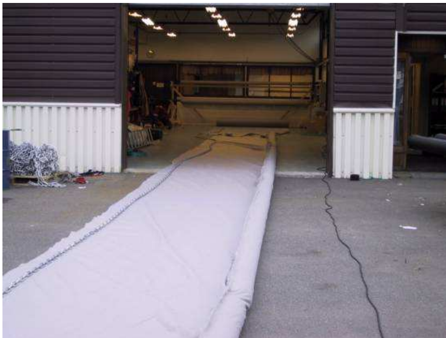
Figur 19. Siltgardin under produksjon i pilotprosjektet i Sandefjord. Flytere er sydd inn på toppen av gardinen (til høyre) og kjetting som skal fungere som lodd skal sys inn (til venstre).
