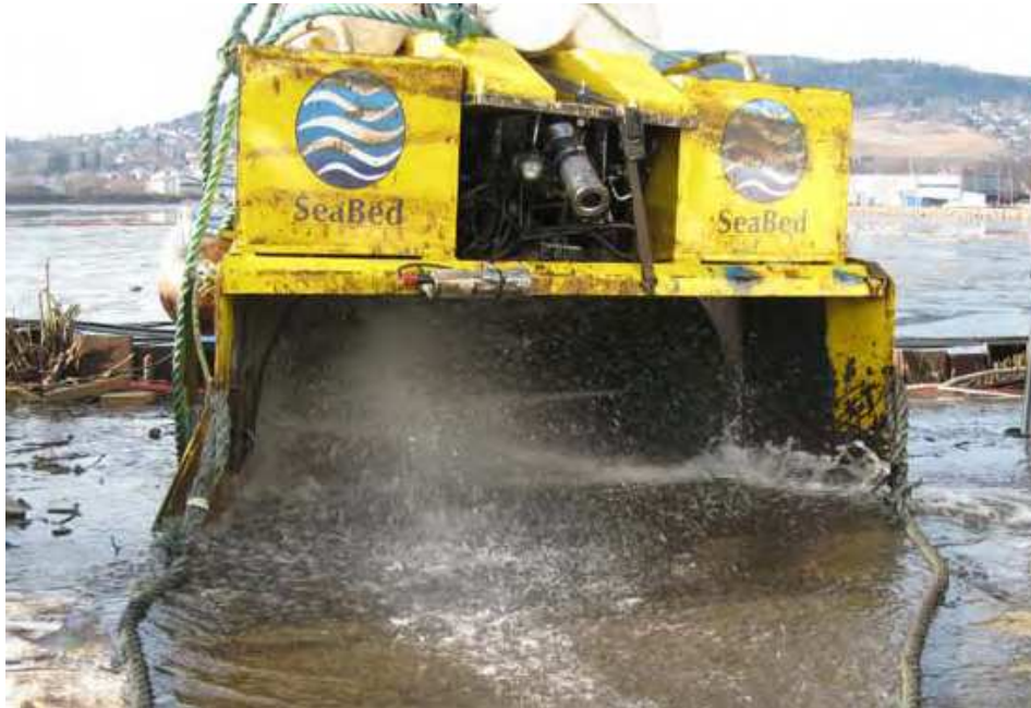
Figur 14. Mudringsutstyr brukt ved Gilhusbukta, Lier for å mudre klebrige kreosotholdige masser (Seabed Services)
