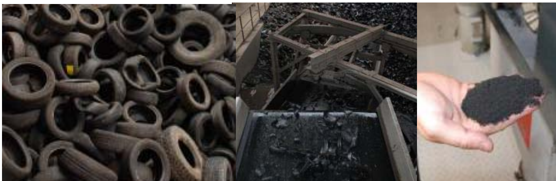
Figur 2: Bildekk kappes opp og kvernes til gummigranulater (Teknisk ukeblad, 2011)
