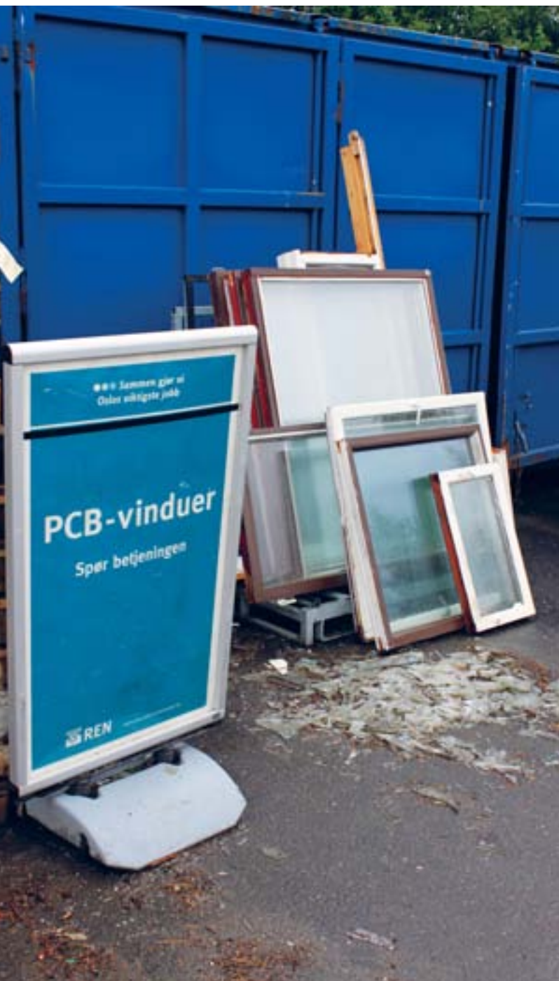
Innlevering av PCB-holdige isolerglassruter. Kilde: Riksrevisjonen
