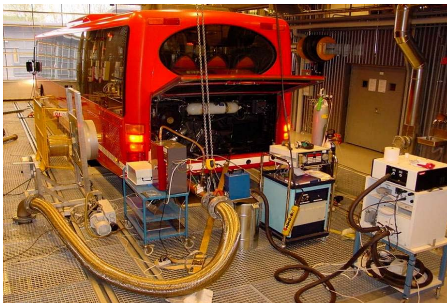
Figur V.1.4. VTTs avgasslaboratorium med programmerbar rullende landevei for tunge kjøretøy i Vantaa utenfor Helsinki (Nylund, VTT, 2005).
