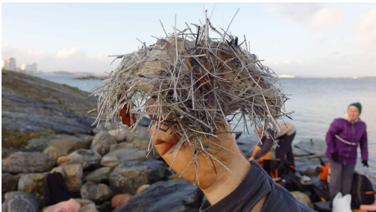
Figur 6-4: Plastarmeringsfibre som trolig stammer fra Ryfast. Bilde: Erik Thoring v/ Naturvernforbundet i Rogaland
