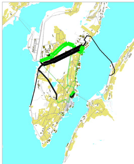
Figur 74 Ny tunnel mellom Breivika og Langnes vil overføre trafikken til tunnelen (svart farge) og redusere trafikkmengden på Erling Kjeldsens veg. (grønn farge) (differanseplot 2014, SVV 2010d)
