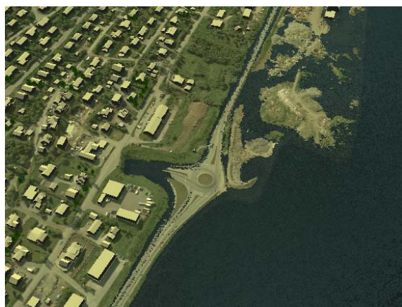
Figur 50 Simulering av mulig økning av havnivået ved stormflo i 2050 viser at tunnelinnslaget på Tomasjord vil stå under vann (illustrasjon Tromsø kommune, byutvikling)
