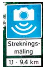
Figur 2.1: Eksempel på skilting av streknings-ATK.
