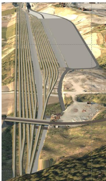
Figur 2-3: Skisse over terminalområdet til Torgård som er lagt til grunn i Utredningen. Ventesporene til venstre, videre lastespor og lagringsområde ytterst til høyre.
