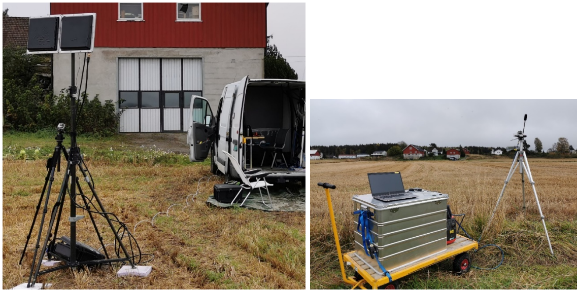
Figur 6.2 FMCW kortholdsradar venstre panel og støyjammer høyre panel
