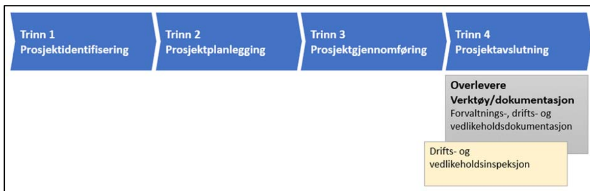
Figur 6.2-1 Drifts- og vedlikeholdsinspeksjonens plass i projektavslutning i Statens vegvesens 4-trinns modell for projektstyring.
