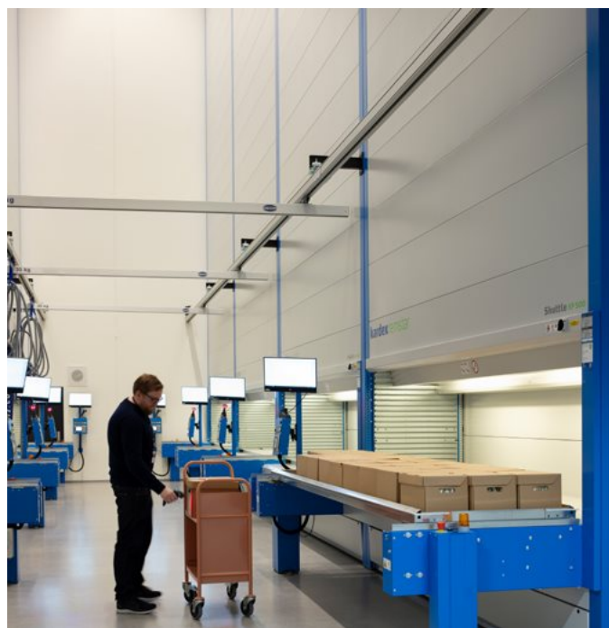
Automatisert mellomlagerløsning på nesten 4000 hyllemeter. Foto: Trond Isaksen
