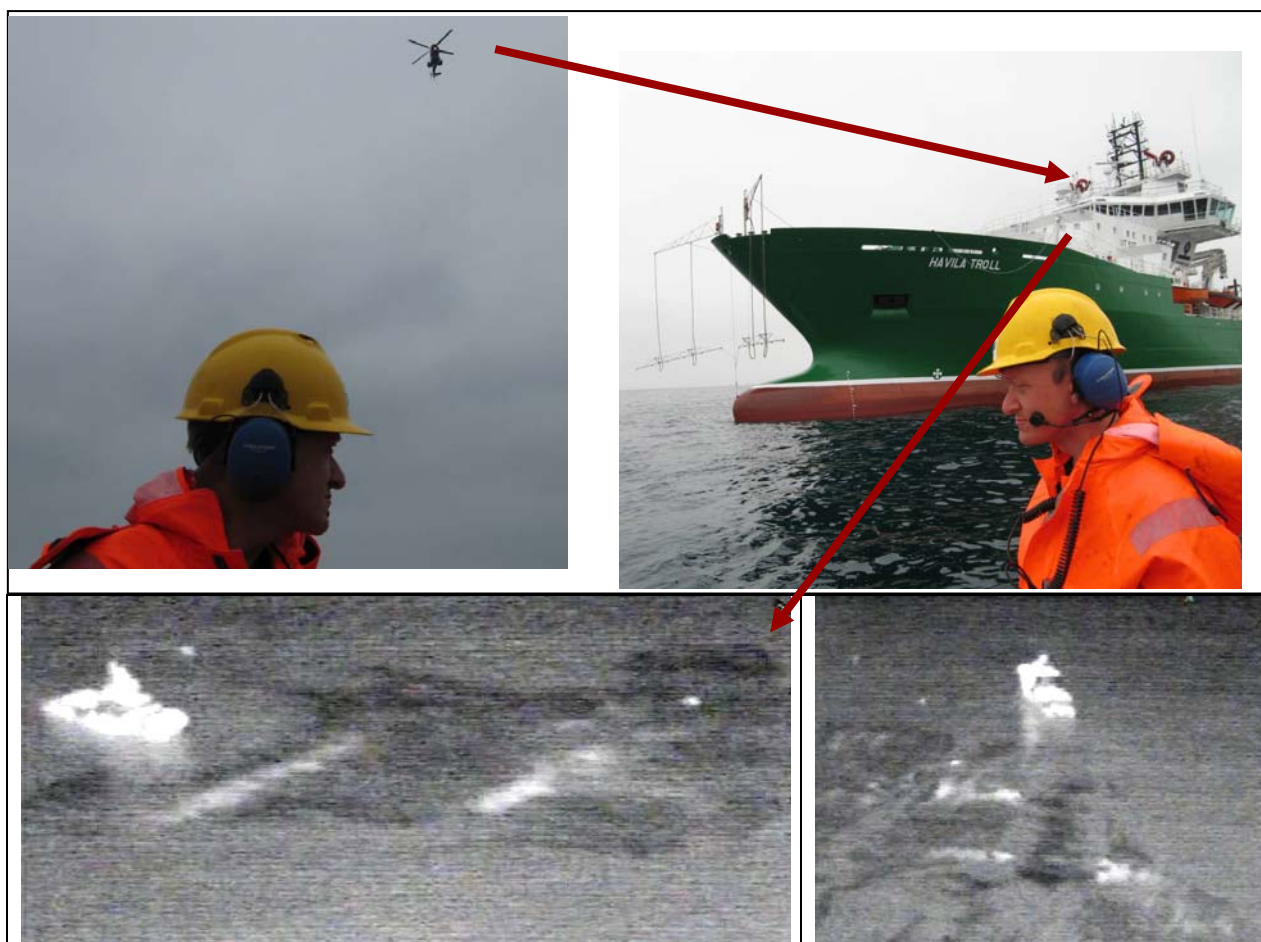
Figure 4.7 Bruk av "down-link FLIR-opptak fra helikopter til påføringsbåten Havila Troll (NOFO 2006). "Real-time" FLIR-opptak fra helikopter ble sendt ned til Havila Troll under påføringsoperasjonen.
