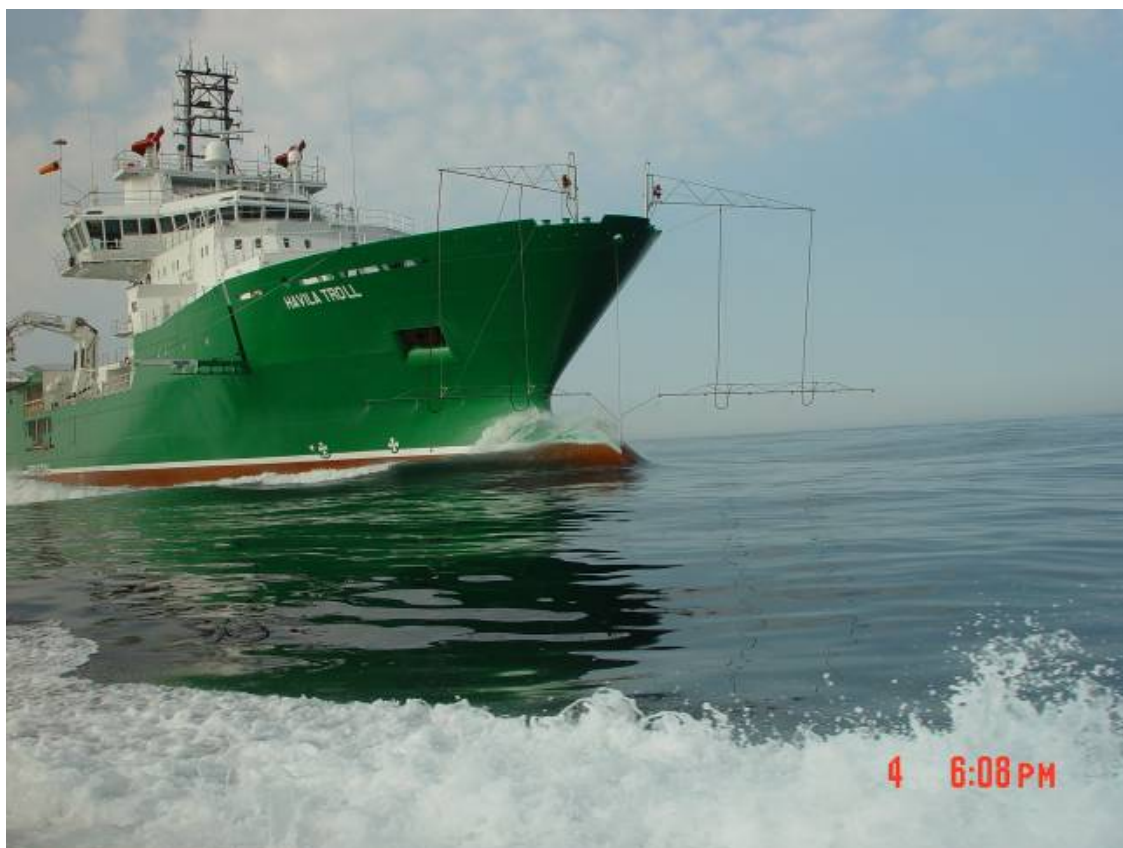
Figur 2.6 Felttesting av påføringsutstyr for dispergeringsmiddel på "Havila Troll" (Foto: SINTEF).
