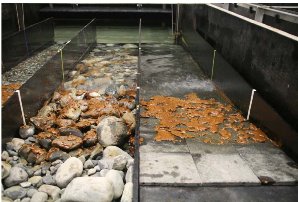
Figur 2.7 Testing av hvordan en forvitret olje kleber seg til forskjellige strandsubstrater og i hvilken grad flo og fjære kan påvirke utvasking. (Bilde: SINTEF).
