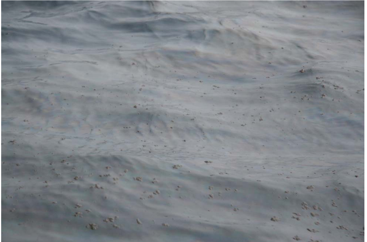
Figur 2.12 Klumper med emulsjon, tentativt 1 – 10 cm, i område med tynn oljefilm (Kilde: Melbye et al., 2007).
