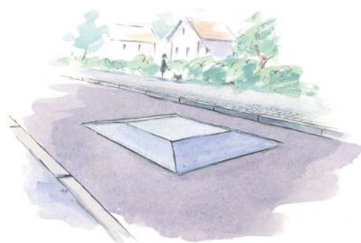
Figur 4.26 Fartspute av prefabrickerte betongelementer
