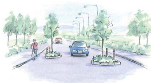
Figur 2.7 Innsnevring og sideforskyvning
