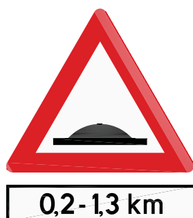
Figur 4.20 Fareskilt 109 «Fartshump» med underskilt 804 «Utstrekning»
