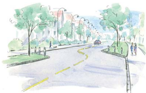
Figur 5.6 Sideforskyvning av tofeltsveg
