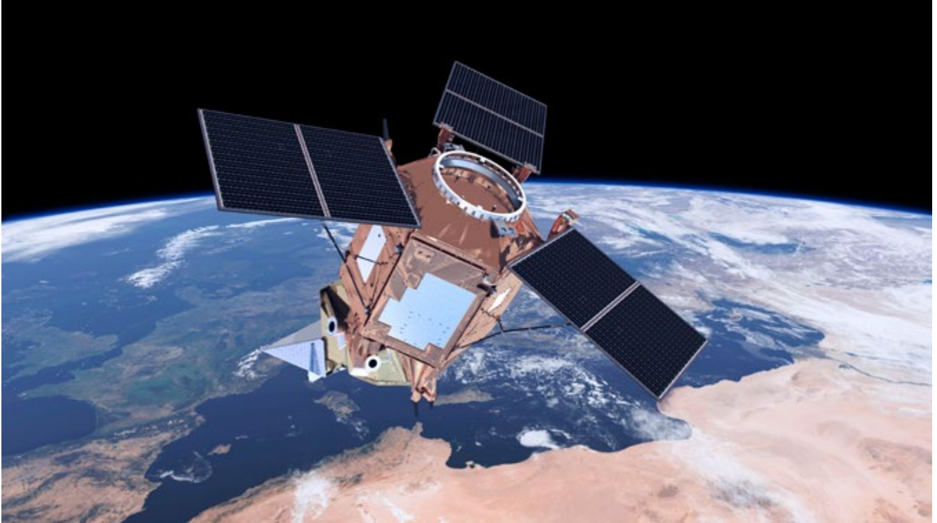
Sentinel-5P måler luftkvaliteten over hele verden. Det inkluderer gasser som metan, ozon og svoveldioksid. Illustrasjon: ESA
