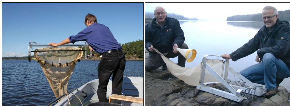
Figur 2. Bunnråller for fangst av istidskreps. Bildet til venstre viser en svensk tråltype utviklet av Magnus Fürst. Trålen til høyre er produsert ved Kanalmuseet. Noen kjettinger fremst på trålsleden virvler opp bunnssubstratet, og mudder og eventuelle dyr fanges opp i trålposen. (Foto: Jan P. Vaaler (t.v.) og Ingvar Spikkeland).
