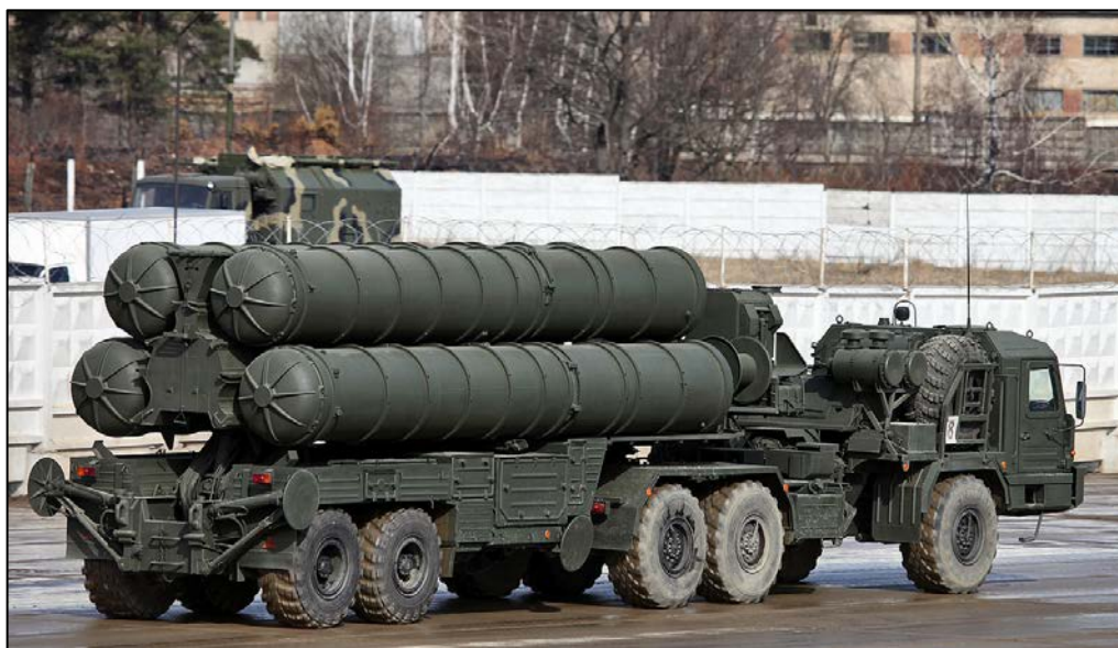
Figur 3.7 TEL for SA-21 Growler (S-400) fotografert i 2014. De fire utskytningsrørene reises opp som én enhet før utskytning. (Foto: Vitalij V. Kuzmin, lisensiert under Creative Commons Attribution-Share Alike 4.0 via Wikimedia Commons.)
