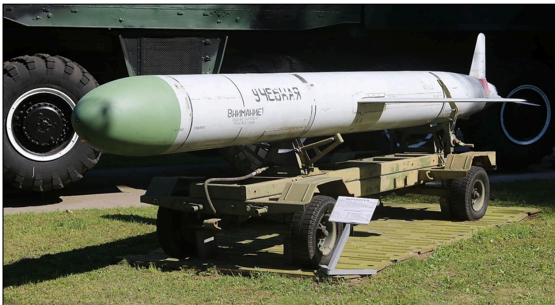
Figur 5.2 AS-15A Kent (Kh-55) fotografert ved det ukrainske luftforsvarsmuseet i Vinnitsia i 2016. De store vingene midt på lagres inni missilet og spretter ut etter utskytingen. (Foto: George Chernilevsky via Wikimedia Commons, offentlig eiendom.)
