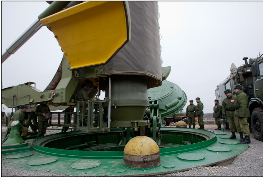
Figur 3.4 Nedlasting i silo av SS-27 Mod 1 (Topol-M). Bildet er tatt i 2015 av det russiske forsvaret. (Foto fra mil.ru lisensiert under Creative Commons Attribution 4.0 International License via Wikimedia Commons.)
