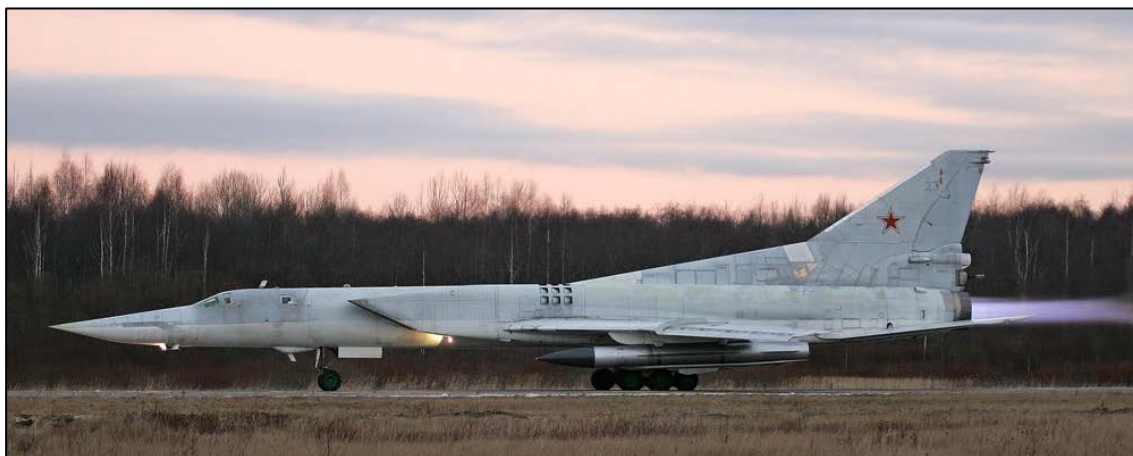
Figur 5.3 Backfire-C (Tu-22M3) fotografert i 2008. Et missil av type AS-4 Kitchen (Kh-22) er montert under buken på flyet. (Bildet er tatt av Dmitrij Pitsjugin og er lisensiert under GNU Free Documentation License Version 1.2 via Wikimedia Commons.)
