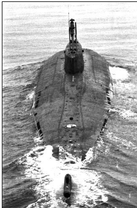
Figur 4.5 Ubåt av Oscar II-klassen sett bakfra. Ubåten er svært bred, og det skyldes i første rekke de 24 kryssermissilene som ligger i tolv utskytningsrør på hver side av tårnet. Lukene kan skimtes på bildet. Det er seks luker på hver side, og hver luke dekker to utskytningsrør. (Bilde fra U.S. Navy via Wikimedia Commons, offentlig eiendom.)
