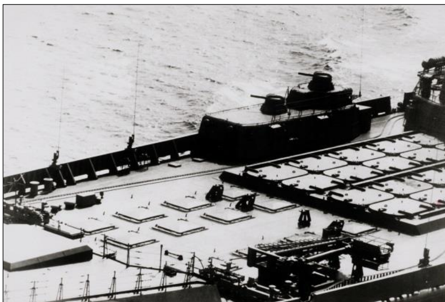
Figur 4.9 Dette bildet er tatt av U.S. Navy i 1985 og viser fordekket på daværende Frunze (senere omdøpt til Admiral Lazarev og tatt ut av tjeneste i 1998). Til høyre sees toppen på 20 utskytningsrør for missiler av typen SS-N-19 Shipwreck, og til venstre toppen på tolv utskytningsrør som hver kan skyte ut åtte missiler av typen SA-N-6 Grumble. På dagens skip av Kirov-klassen er SA-N-6 erstattet av SA-N-20 Gargoyle. (Fra Wikimedia Commons, offentlig eiendom.)
