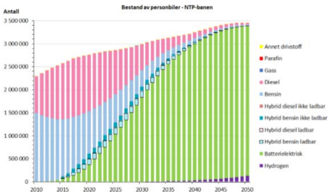
Figur 5: Observert og framskrevet bestand av personbiler, etter drivstoff/energibærer. NTP-banen. Kilde: Fridstrøm (2019b).
