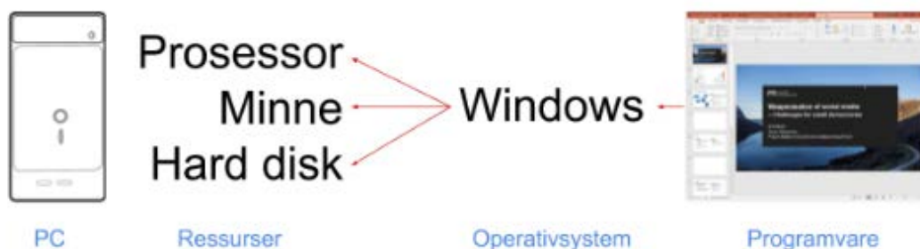
Figur B.1 Forenklet illustrasjon som viser forholdet mellom programvare, operativsystem og noen av maskinvare-ressursene en datamaskin tilbyr.
