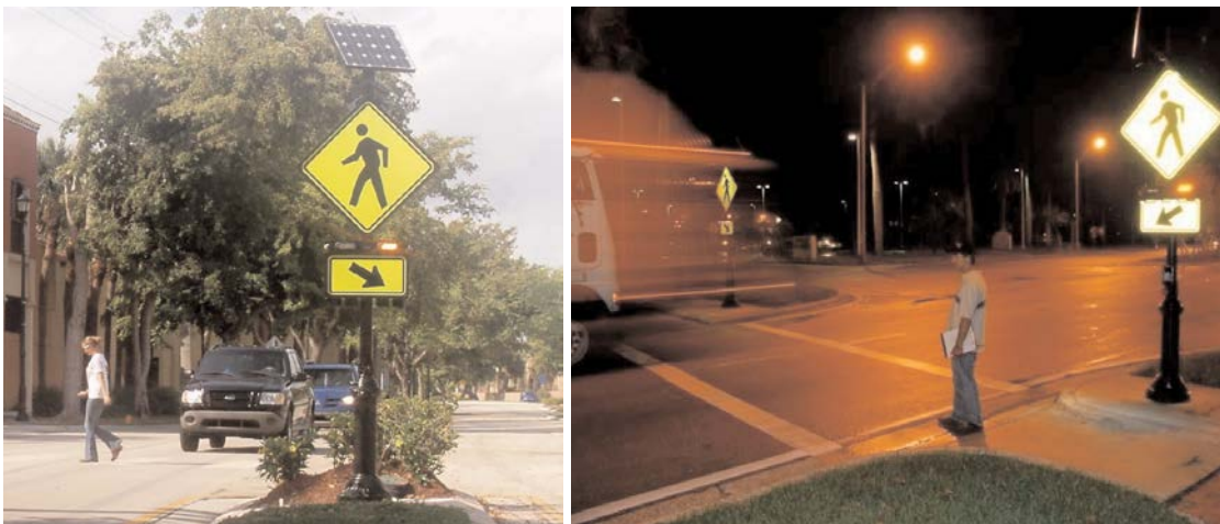
Figur 2.3.2: Fotgjengeraktiver blinklys på fotgjengerovergangskilt på dagtid (venstre) og om natten med behysning av hele skiltet i tillegg (høyre) (Van Houten et al., 2008).
