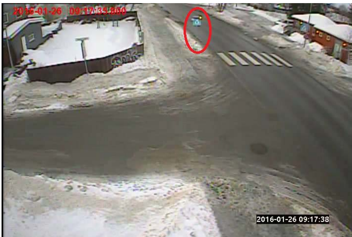
Figur 5.2.3: Falsk alarm – SeeMe blinker (rød sirkel) selv om ingen fotgjengere er ved eller i gangfeltet (gangfelt D1 Industrivegen).
