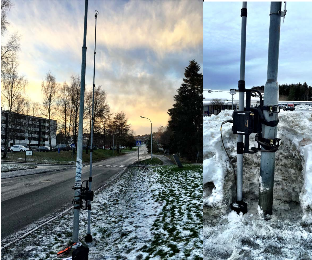
Figur 4.3.1: Videokamera ved gangfelt i Saupstadringen (venstre) og feste til stolpe med boks til batteri og datamaskin (høyre).
