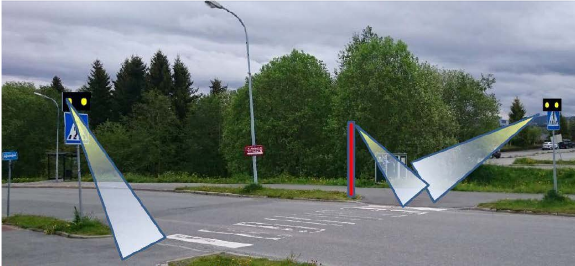
Figur 2.4.1: Skjematiske oppsett av SeeMe og fotgjengerdetektorene (gangfelt B1 Selsbakelia) (Bilde: Ole Erik Raad i Safezone).
