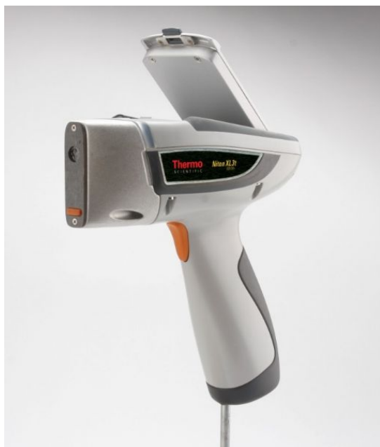
Figur 37. NITON XL 3t er mykje brukt til å måle metallkonsentrasjon direkte på marka. Instrumentet kan undervurdere konsentrasjonen dersom jorda f.eks. er våt.
