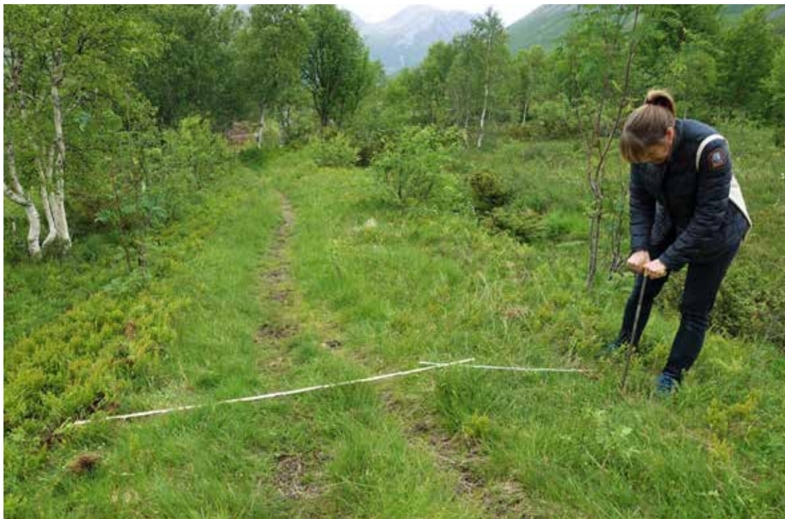
Eit jordbor er ein nyttig reiskap for å sjekke vegmur som ligg godt under torva. Foto: Izabela A. Chlewicka, Statens vegvesen.
