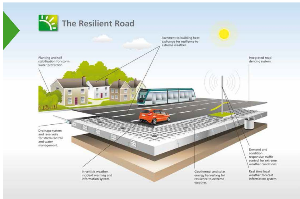
Figur 2 FEHRLs konsept om klimarobust veg, en del av den visjonære «Forever Open Road» [6]
