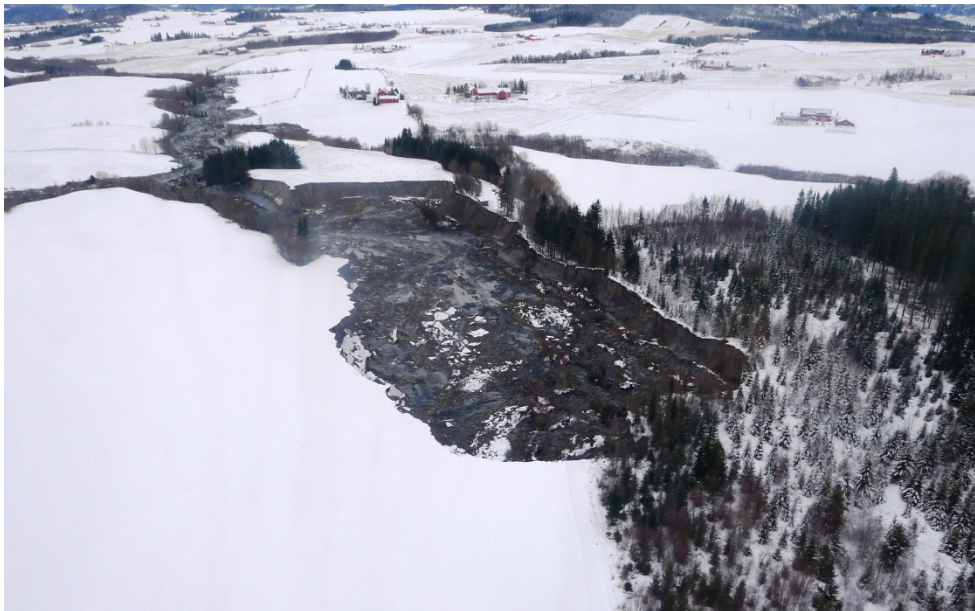
Figur 50. Kvikkleireskred, Byneset, første Nyttårsdag 2012. Foto: Einar Lyche, NVE. Kvikkleireskred er ikke direkte påvirket av at det blir mer nedbør i fremtidig klima. I situasjon der mer avrenning kan føre til mer mekanisk påkjenning og erosjon, er det imidlertid mulig at skred blir utløst uten menneskelig påvirkning.
