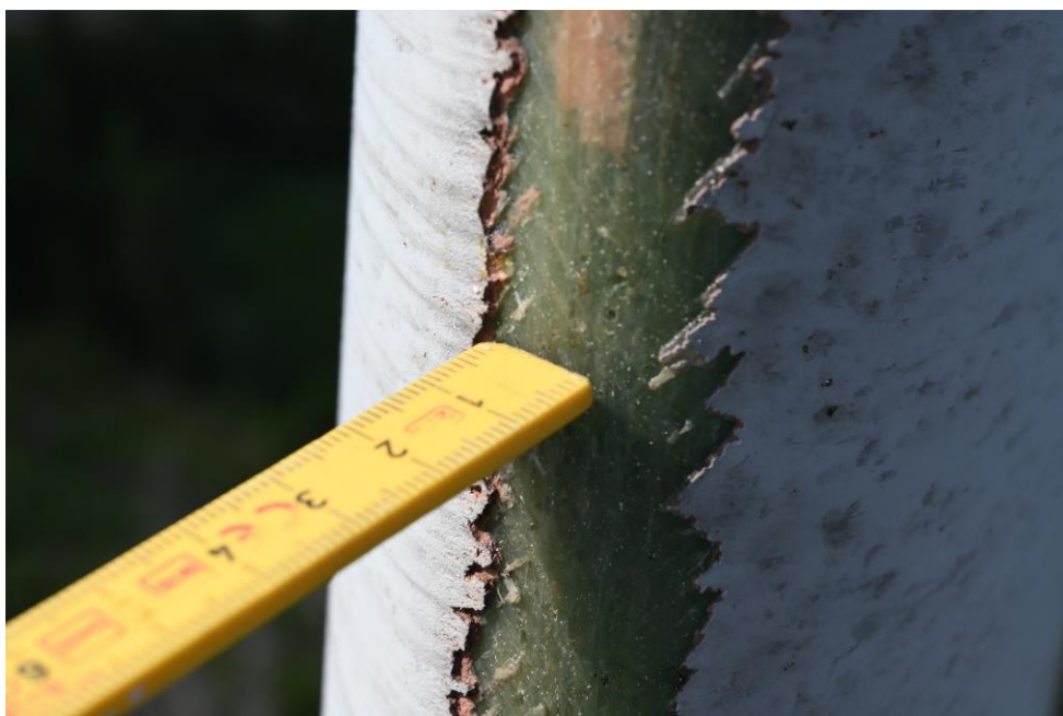
Figur 3 Kanterosjon på et rotorblad i Norge (Bilde: Thomas Mo Willig, NVE)
