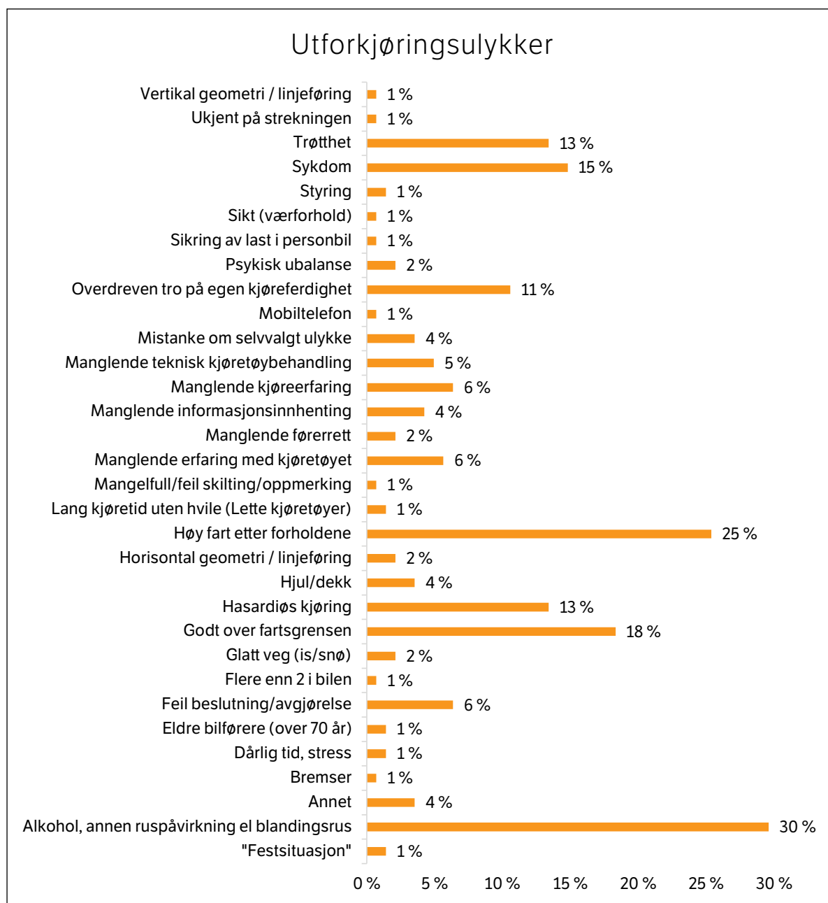
Figur 2.1.2.1: Faktorer som kan ha medvirket til at utforkjøringsulykker skjedde (andel av alle utforkjøringsulykker), 2005-2014. Bare faktorer som har hatt store eller avgjørende betydning til at ulykken skjedde er presentert.
