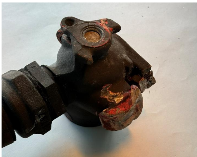
Figur 8: Hovedledningskranen fra første vogn med knekt hendel. Foto: SHK
