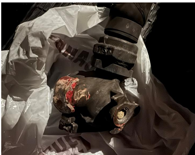
Figur 7: Hovedledningskranen fra første vogn med knekt hendel. Foto: SHK
