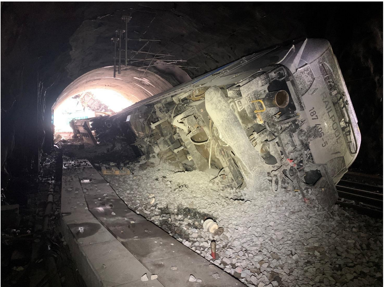
Figur 4: BR187 etter avsporing i Arnanipatunnelen. Foto: SHK
