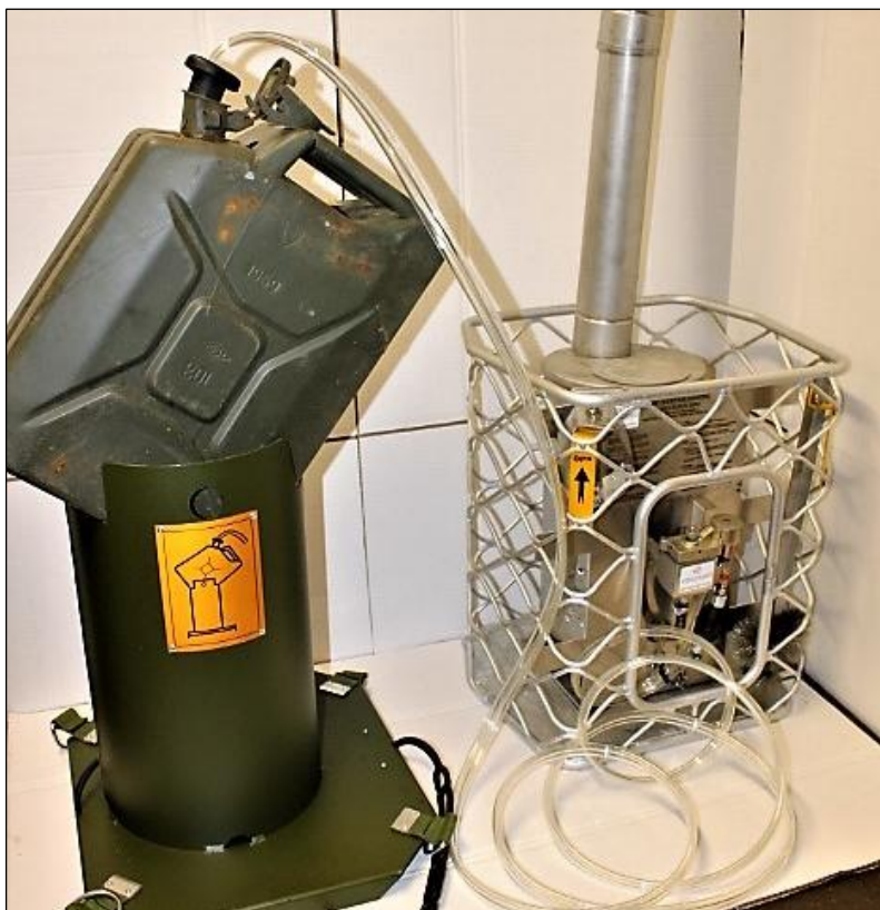
Figur 2: Teltovnen M94 ferdig montert, og klar til bruk. Foto: Olav Teigen Maskinforretning
