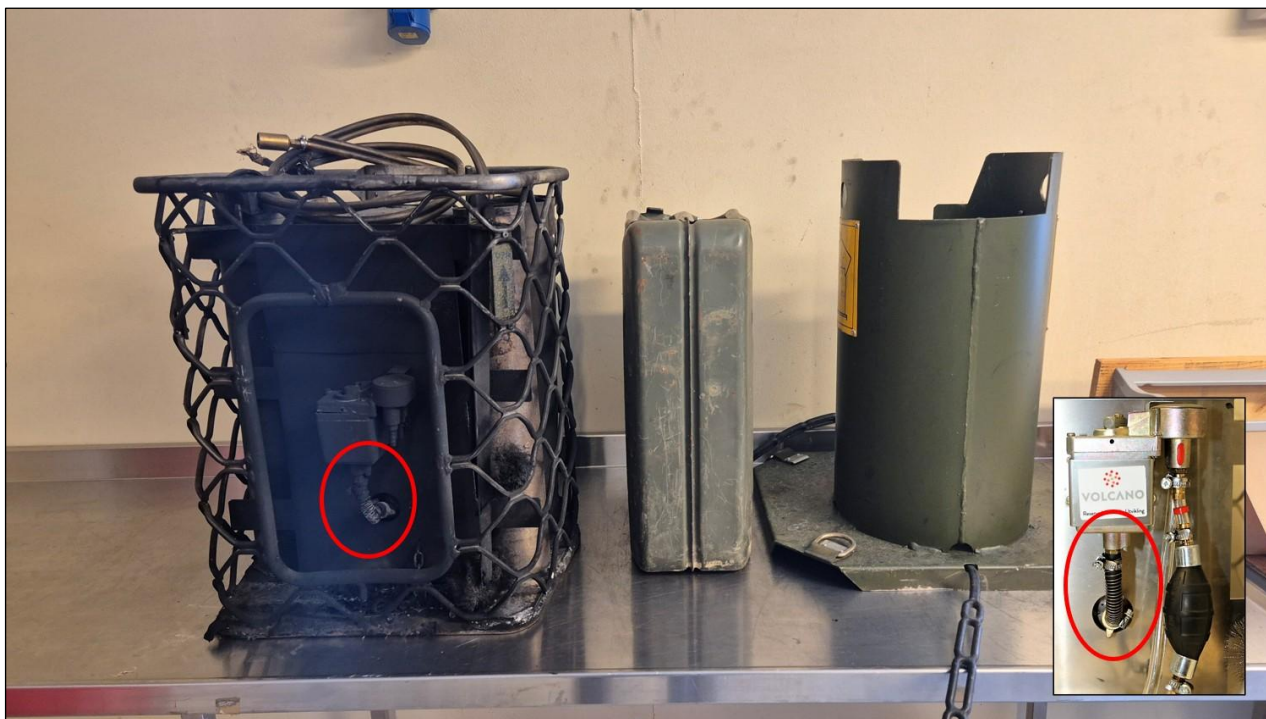
Figur 3: Tydelig brannpåvirket M94 teltovn. Rød sirkel viser området der slangestussen inntil brennkammeret satt. Foto: SHK / Olav Teigen Maskinforretning (innfelt)
