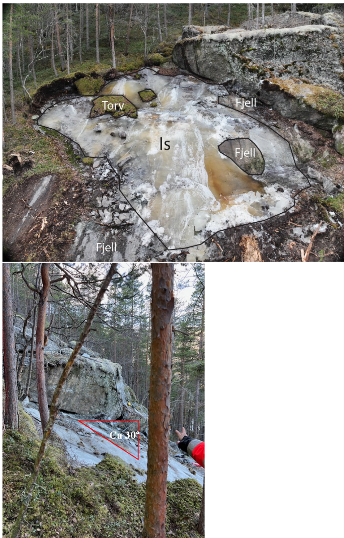
Figur 3-2 (A) Foto av glideflaten tatt 31. mars 2025 (Marius Grøndal, SVV) viser en nesten gjennomgående isflate. (B) Foto av glideflaten tatt under befaringen 7. april 2025.
