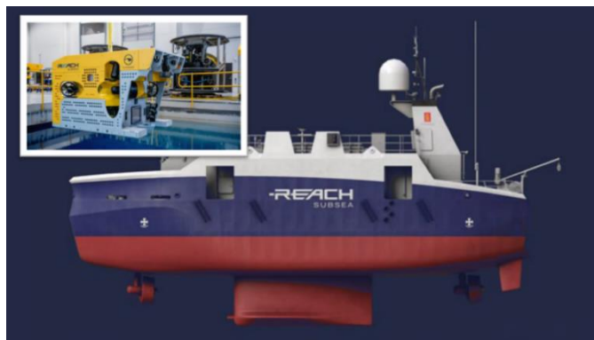
Figur 4.4: Reach Subsea med partnere er et eksempel på teknologi hvor ubemannet overflatefartøy brukes i kombinasjon med ROV. Bildet er gjengitt med tillatelse fra Reach Subsea.
