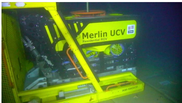
(a) IKM's R-ROV med tilhørende «garasje»,
