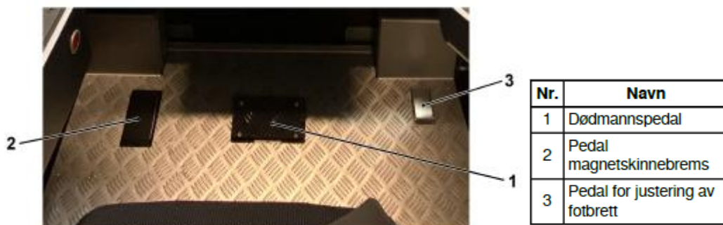
Figur 13: Pedaler på førerplass. Kilde: Førerhåndbok, Sporveien Trikken AS
