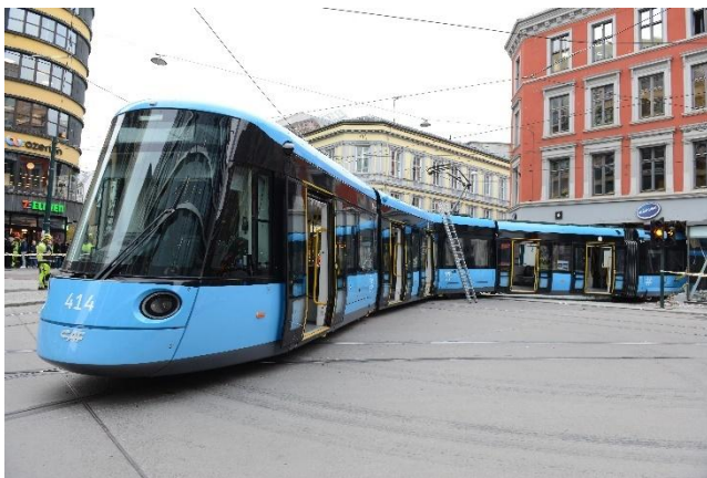
Figur 4: SL18 414 i sluttposisjon etter avsporing og sammenstøt. Foto: SHK
