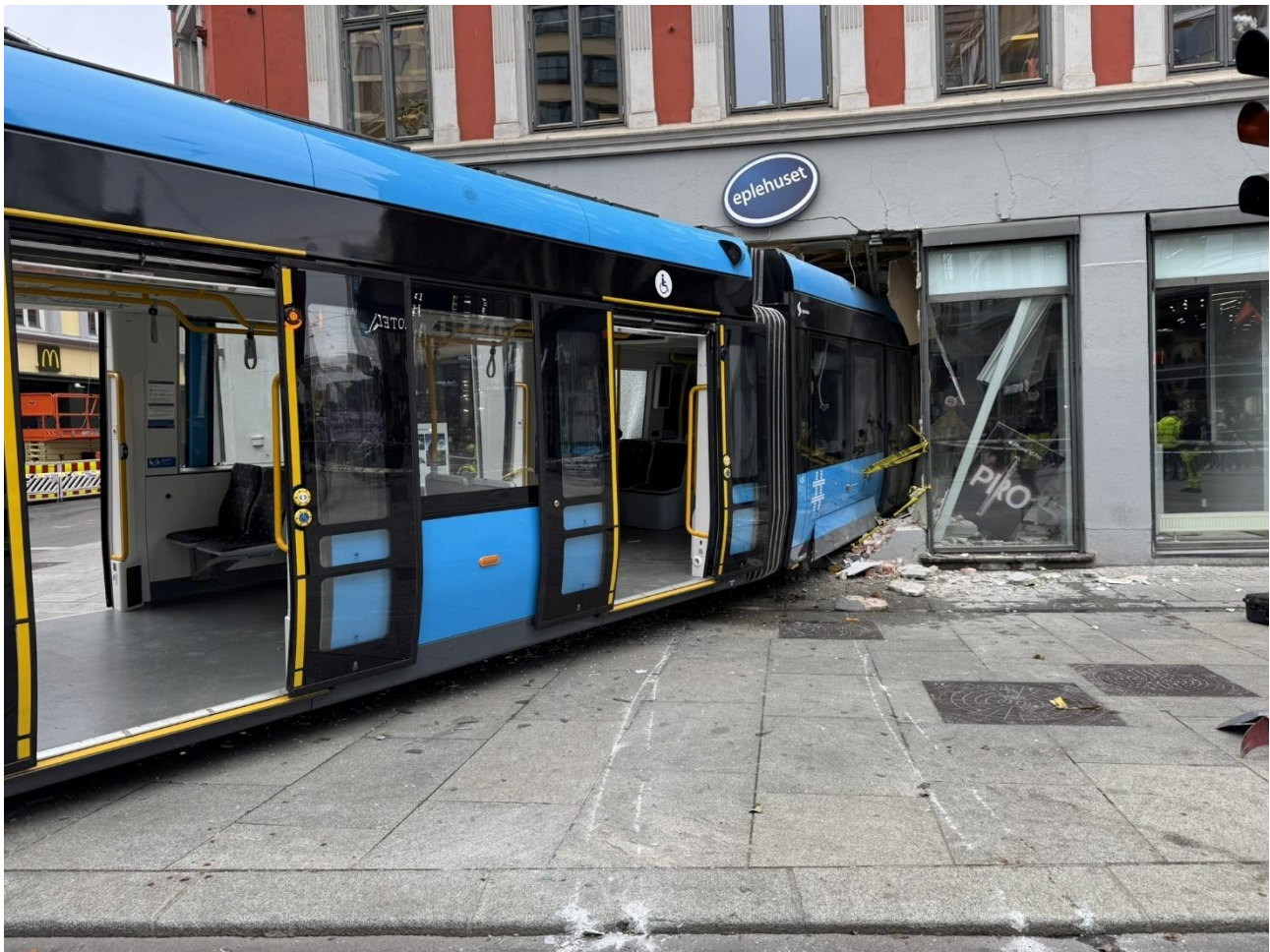
Figur 3: SL18 414 i sluttposisjon. Spor fra hjulflenser i granitthellene på fortauet. Foto: SHK
