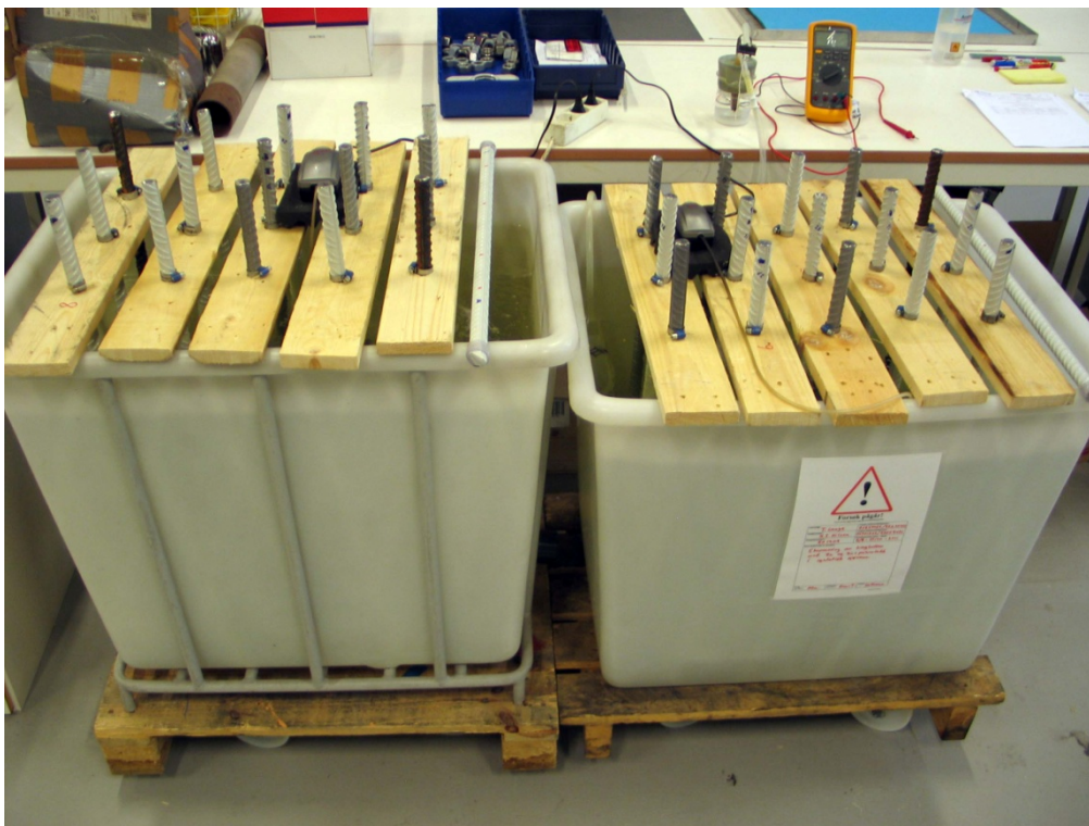
Figur V5-6. Forsøksoppsett med luftbobling (akvariepumper) og utstyr for potensialmåling.
