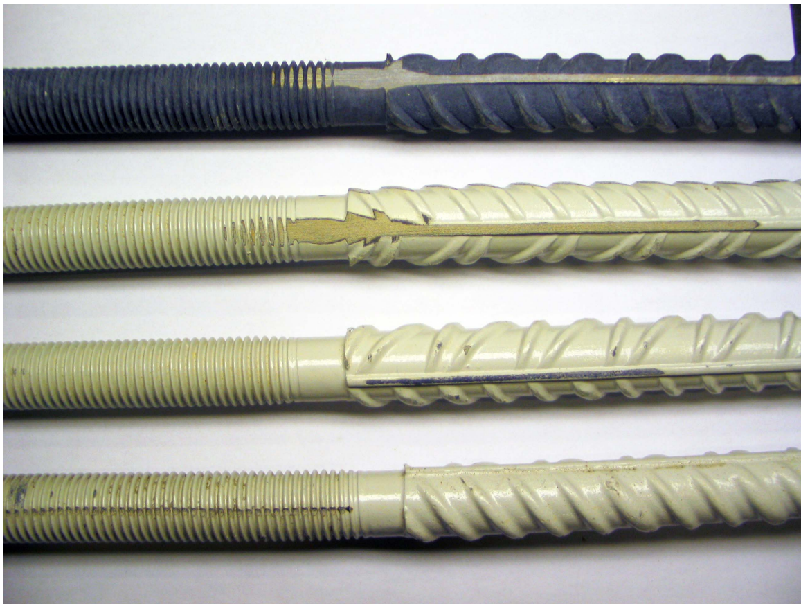
Figur 18. Foto av bolter som representerer alle skadescenarier etter 7 ukers eksponering.
