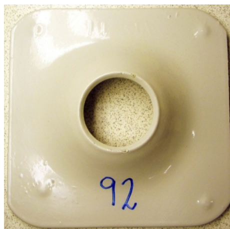
Figur 31. Foto av fritthengende skive med VF+PL uten skade før og etter 13 ukers eksponering. Eksponert komponent er rengjort med en bløt klut for å fjerne misfarging og løse avsetninger
