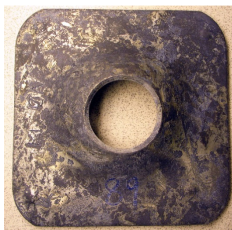
Figur 28. Foto av fritthengende skive med varmforsinking uten skade før og etter 13 ukers eksponering. Eksponert komponent er rengjort med en bløt klut for å fjerne misfarging og løse avsetninger.
