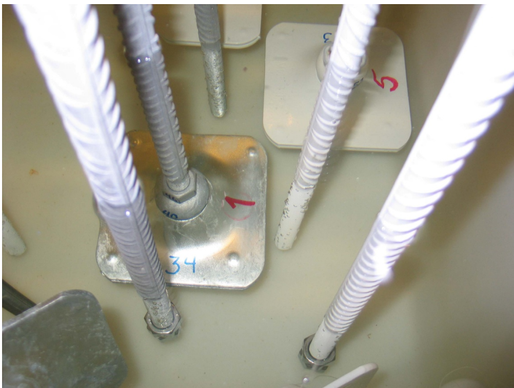
Figur V5-7. Neddykkede bolter og komponentsystemer rett etter oppstart (ca. 50 cm dybde).
