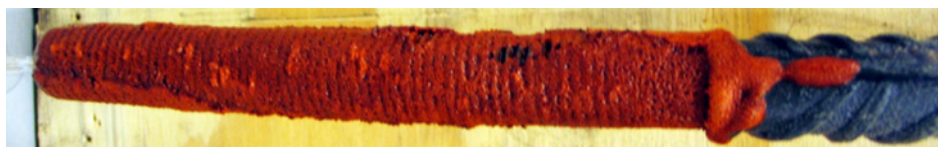
Figur 15. Foto av bart stål bolt før og etter 7 ukers eksponering.
