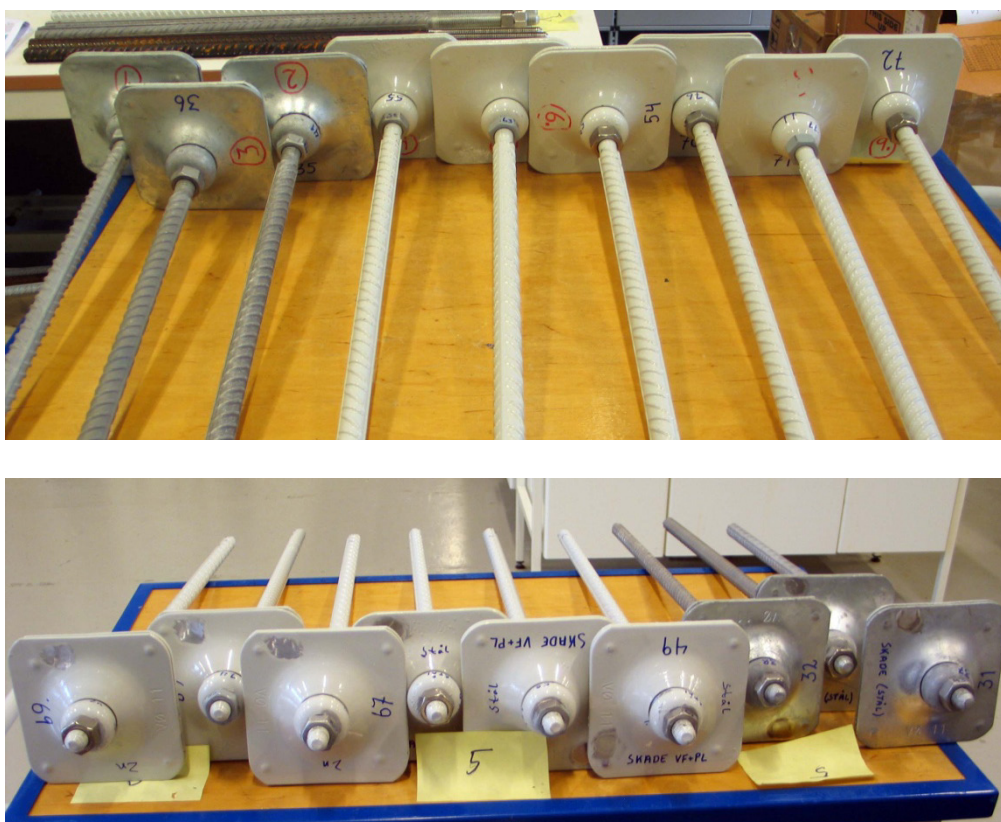
Figur V5-2. Komplette komponentsystemer med skader klare til test. Tiltrekkingsmoment = 125 kN.
