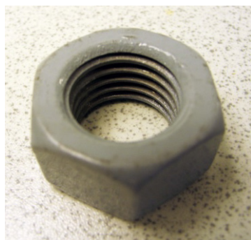
Figur 33. Foto av fritthengende mutter med VF+PL uten skade før og etter 13 ukers eksponering. Eksponert komponent er rengjort med en bløt klut for å fjerne misfarging og løse avsetninger
