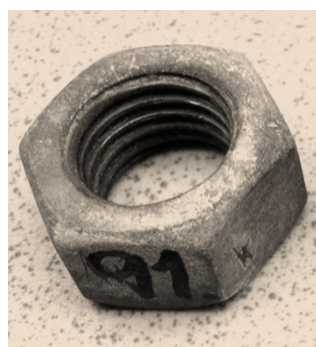
Figur 30. Foto av fritthengende mutter med varmforsinking uten skade før og etter 13 ukers eksponering. Eksponert komponent er rengjort med en bløt klut for å fjerne misfarging og løse avsetninger
