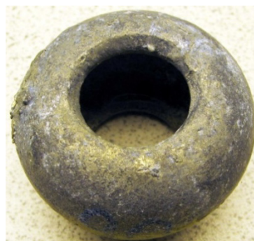
Figur 29. Foto av fritthengende halvkule med varmforsinking uten skade før og etter 13 ukers eksponering. Eksponert komponent er rengjort med en bløt klut for å fjerne misfarging og løse avsetninger.
