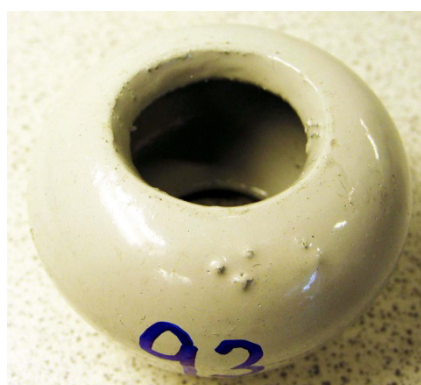
Figur 32. Foto av fritthengende halvkule med VF+PL uten skade før og etter 13 ukers eksponering. Eksponert komponent er rengjort med en bløt klut for å fjerne misfarging og løse avsetninger.
