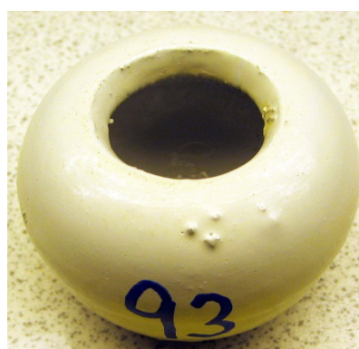
Figur 32. Foto av fritthengende halvkule med VF+PL uten skade før og etter 13 ukers eksponering. Eksponert komponent er rengjort med en bløt klut for å fjerne misfarging og løse avsetninger.
