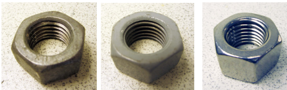
Figur 6. Standard metriske M20 muttere (grovgjenget). Venstre: Karbonstål med VF, Midten: Karbonstål med VF + PL, Høyre: Syrefast
