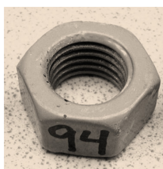
Figur 33. Foto av fritthengende mutter med VF+PL uten skade før og etter 13 ukers eksponering. Eksponert komponent er rengjort med en bløt klut for å fjerne misfarging og løse avsetninger
