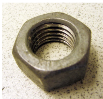
Figur 30. Foto av fritthengende mutter med varmforsinking uten skade før og etter 13 ukers eksponering. Eksponert komponent er rengjort med en bløt klut for å fjerne misfarging og løse avsetninger
