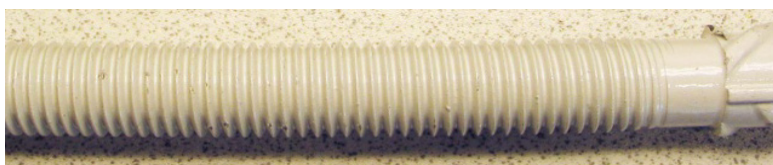
Figur 26. Foto av fritthengende bolt med varmforsinking (VF) uten skade før og etter 13 ukers eksponering.
