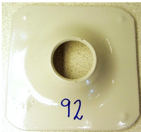
Figur 31. Foto av fritthengende skive med VF+PL uten skade før og etter 13 ukers eksponering. Eksponert komponent er rengjort med en bløt klut for å fjerne misfarging og løse avsetninger
