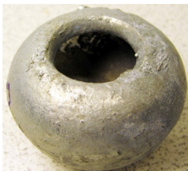
Figur 29. Foto av fritthengende halvkule med varmforsinking uten skade før og etter 13 ukers eksponering. Eksponert komponent er rengjort med en bløt klut for å fjerne misfarging og løse avsetninger.
