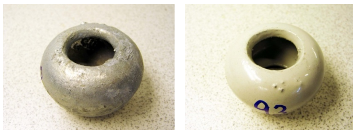
Figur 4. Halvkuler, Ø50, hull Ø22. Venstre: VF. Høyre: VF+PL.
