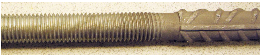
Figur 25. Foto av fritthengende bart stål bolt før og etter 13 ukers eksponering.
