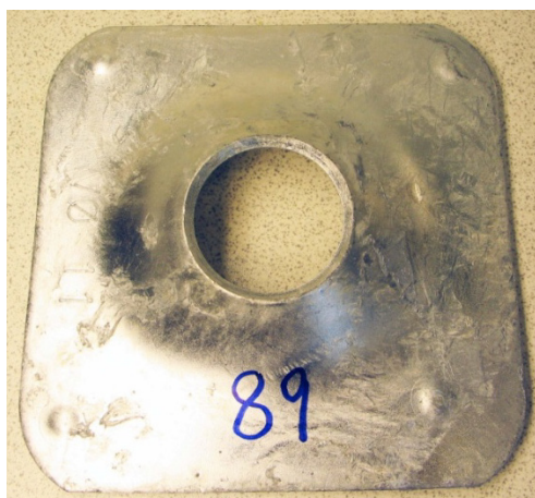
Figur 28. Foto av fritthengende skive med varmforsinking uten skade før og etter 13 ukers eksponering. Eksponert komponent er rengjort med en bløt klut for å fjerne misfarging og løse avsetninger.
