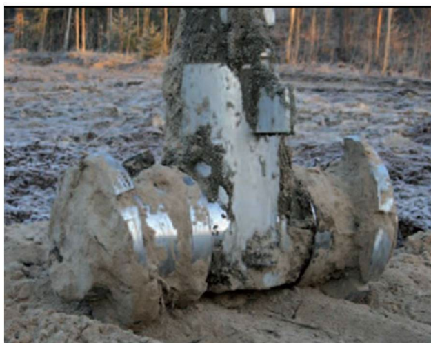
Figur 1-3: Eksempel på visp som benyttes ved massestabilisering (Ref. Norcem 2006).
